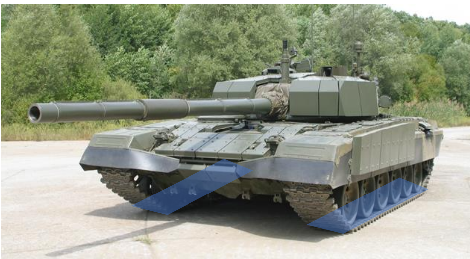
Slika 15. Dodirna površina gusjenica tenka M-84 i podloge [18]
