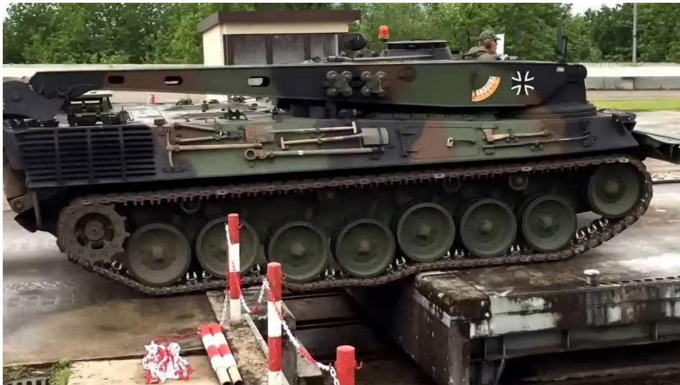
Slika 16. Prelazak vozila na gusjenicama preko rova [21]
