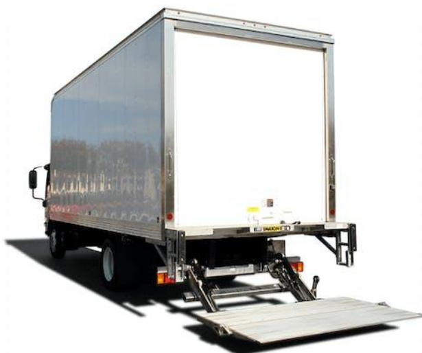
Slika 1. Transportno vozilo sa naknadno ugrađenom utovarnom rampom
