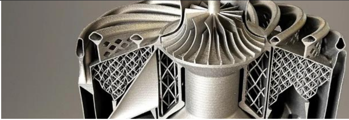
Slika 5. Turbina dobivena SLM postupkom [19]
