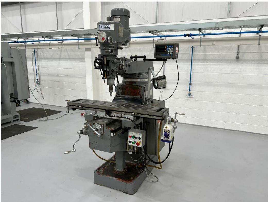
Slika 3. Semco LC-185VS numerički upravljana glodalica [7]
