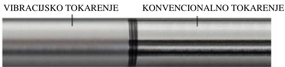
Slika 25. Obradak kod kojeg je s lijeve strane korišteno vibracijsko tokarenje, a desno konvencionalno tokarenje u istim uvjetima [22]
