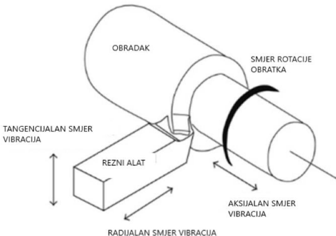
Slika 23. Prikaz glavnih smjerova vibracije alata [22]
