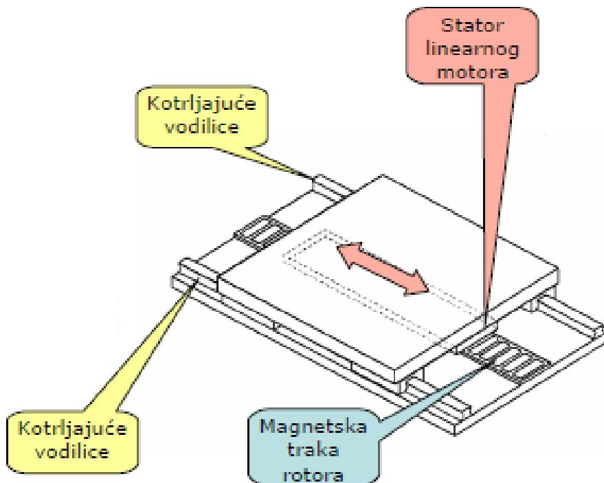
Slika 16. Shematski prikaz linearnega motora [11]
