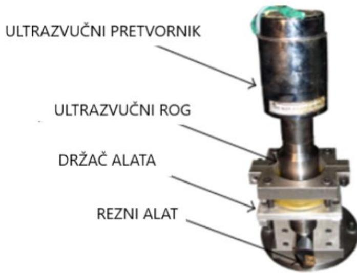
Slika 24. Struktura alata i vibracijskog sustava [22]
