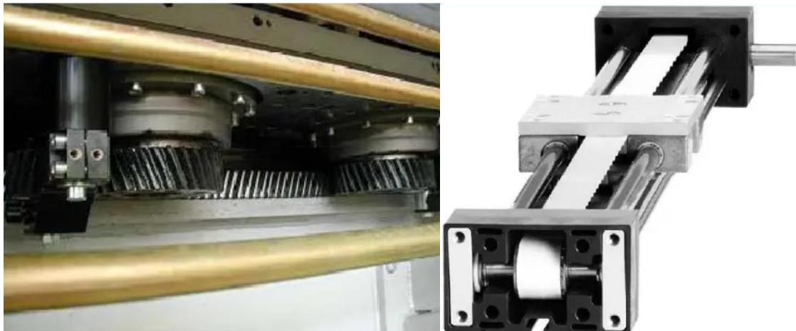
Slika 18. "master-slave" izvedba zupčaste letve (lijevo) i zupčasti remen (desno) [12]
