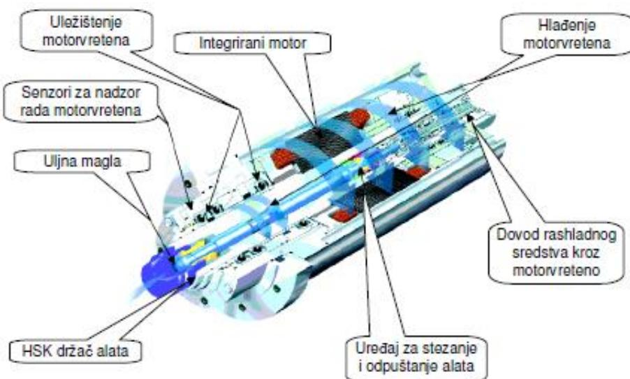
Slika 12. Presjek motorvretena [11]
