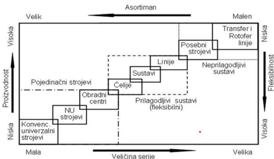
Slika 1. Podjela alatnih strojeva po tehnoškom prostoru [4]
