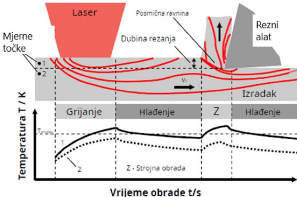
Slika 28. Prikaz zone rezanja u obradi potpomognutoj laserom [19]
