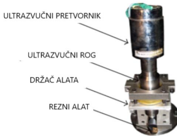
Slika 24. Struktura alata i vibracijskog sustava [22]
