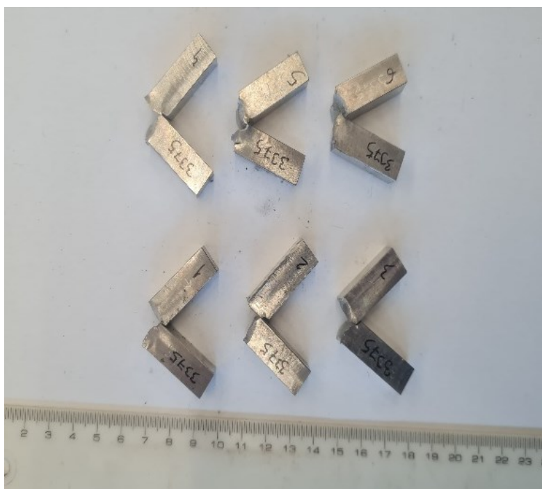
Slika 40. Uzorci na kojima je mjerena žilavost
