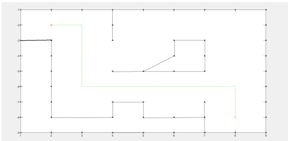
Slika 25 Putanja robota za izlaz u trećem labirintu
