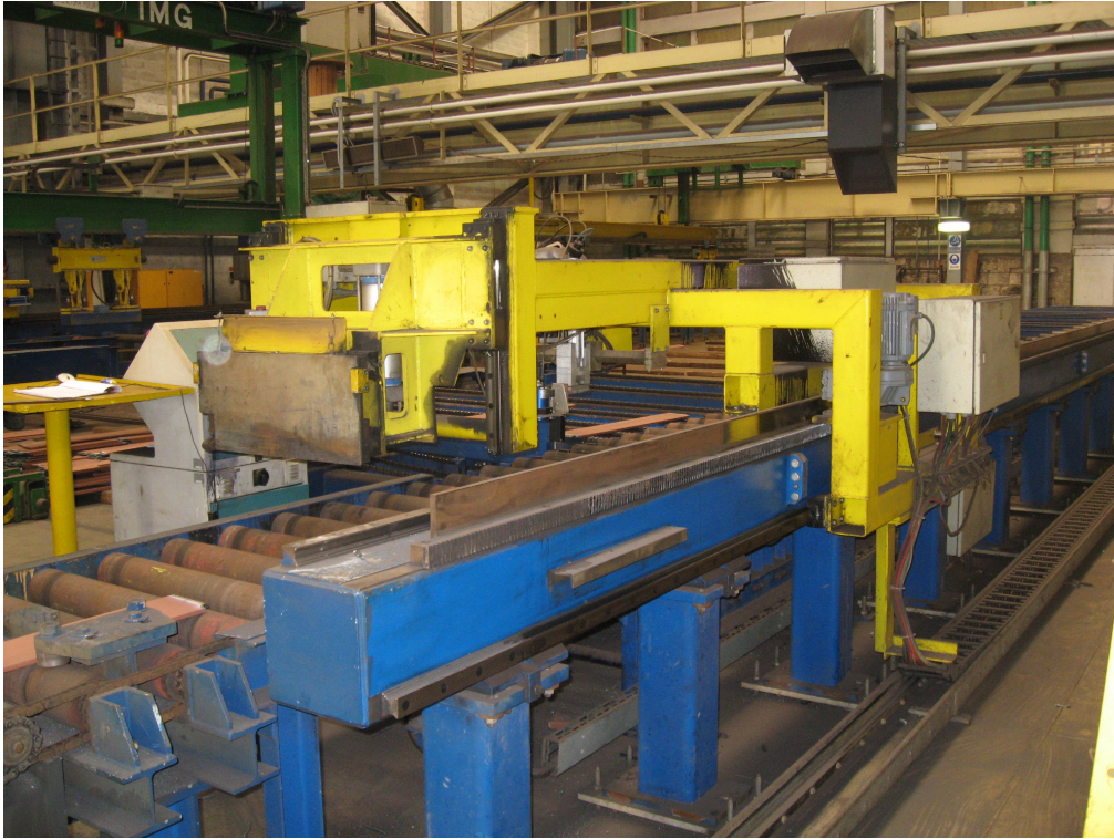
Slika 3.3 - Jedinica za zaustavljanje profila
