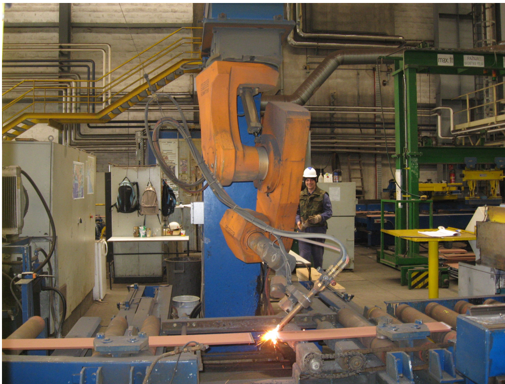
Slika 3.2 - Prikaz robotske ruke prilikom rezanja
