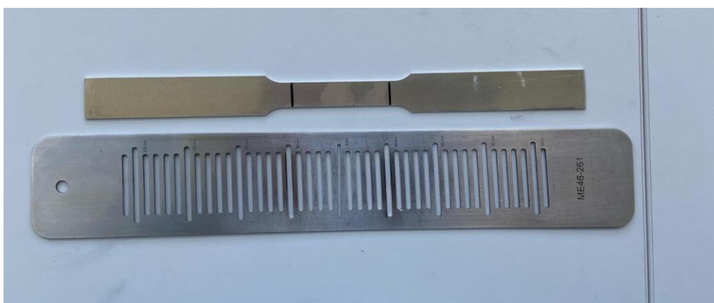
Slika 8. Epruveta za vlačno ispitivanje sa referencama za ekstenziometar
