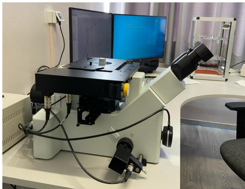
Slika 14. Mikroskop Olympus GX53 Olympus Stream Motion
