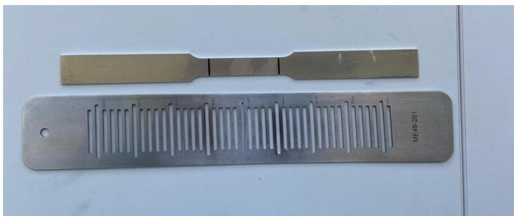
**Slika 8. Epruveta za vlačno ispitivanje sa referencama za ekstensiometar**
