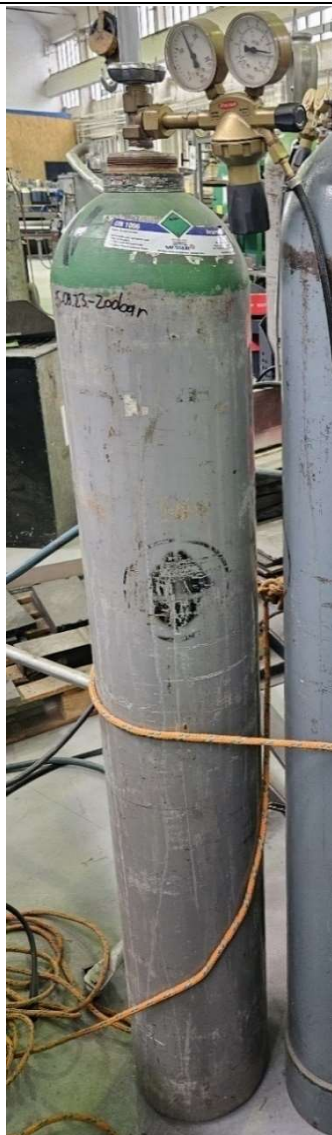
Slika 17. Zaštitni plin argon
