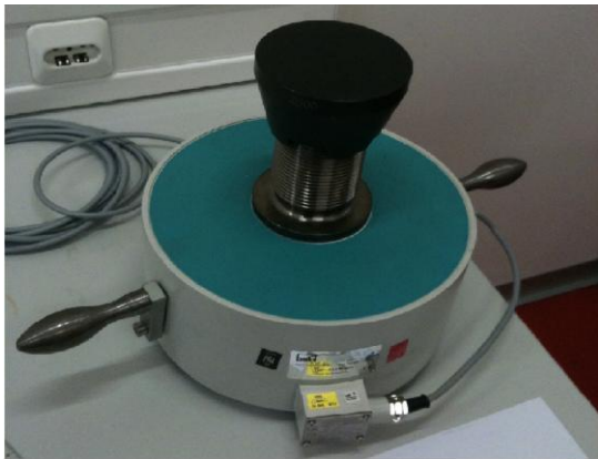
Slika 28. Dinamometar Z4A/500 kN
