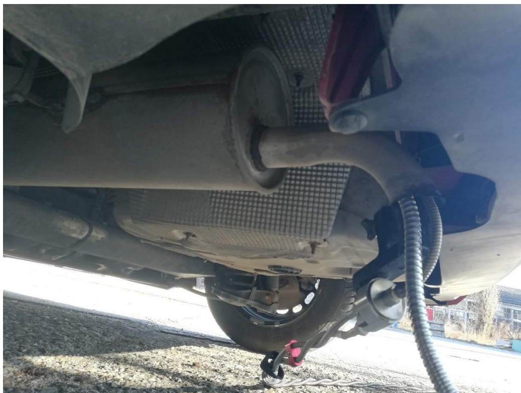
Slika 5.4. Senzor mjernog uređaja u ispušnoj cijevi
