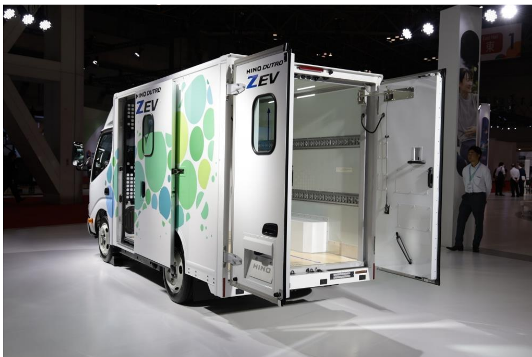
Slika 13. Krilna vrata kod Hino Dutro Z EV [11]
