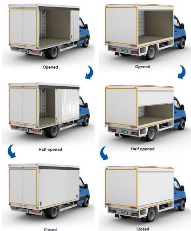
Slika 14. Klizna vrata s aluminijskim profilima (lijevo) i rolo vrata (desno) proizvođača Orten Fahrzeugbau [12]
