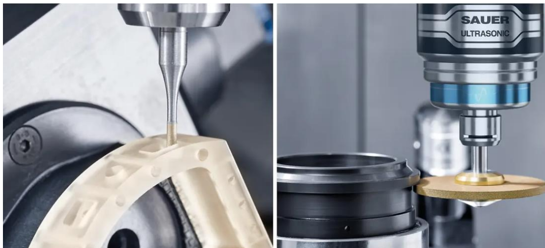
Slika 25. Unutarnje i vanjsko brušenje potpomognuto ultrazvukom rotaciono simetričnih dijelova [22]
