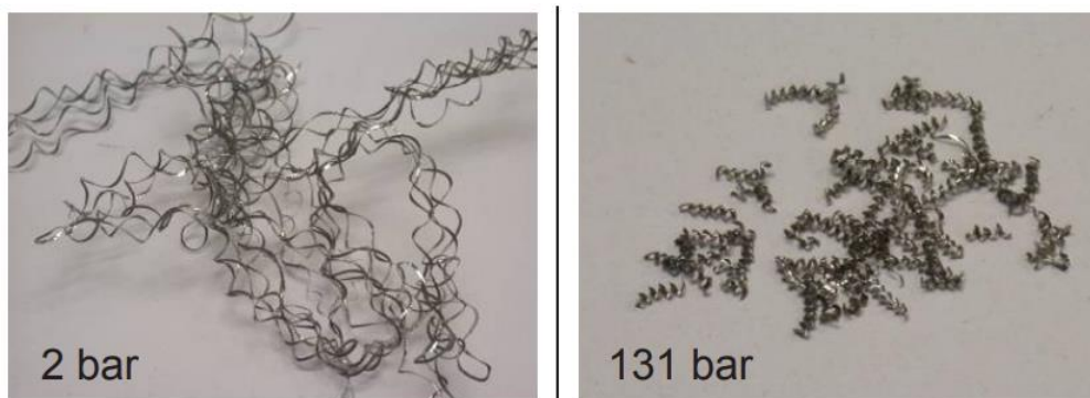
Slika 8. Utjecaj tlaka rashladnog sredstva na odvojenu česticu Inconela 718 [9]
