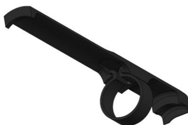
Slika 51. Prikaz ureza izvlakača i izbacivača
