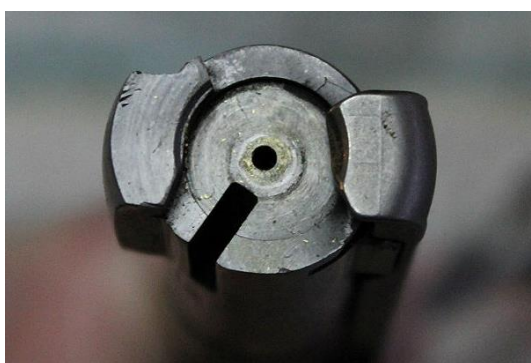
Slika 21. Glava zatvarača mehanizma kontroliranog dovodenja
