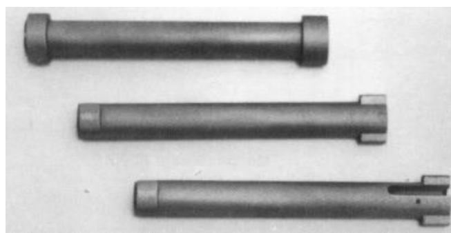
Slika 26. Stadiji izrade zatvarača
