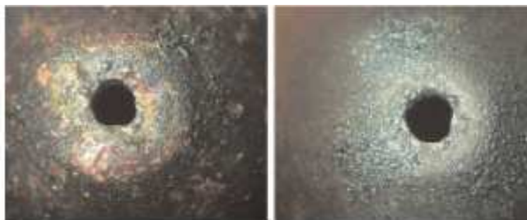
Slika 2.11. Oštećenje vanjskog dijela sapnice [11]
