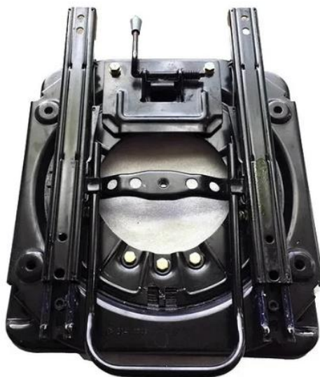
Slika 2. Okretni mehanizam u autima [7]
