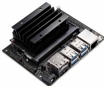
Slika 11. Mikrokontroler Nvidia Jetson Nano Developer Kit-a [8]
