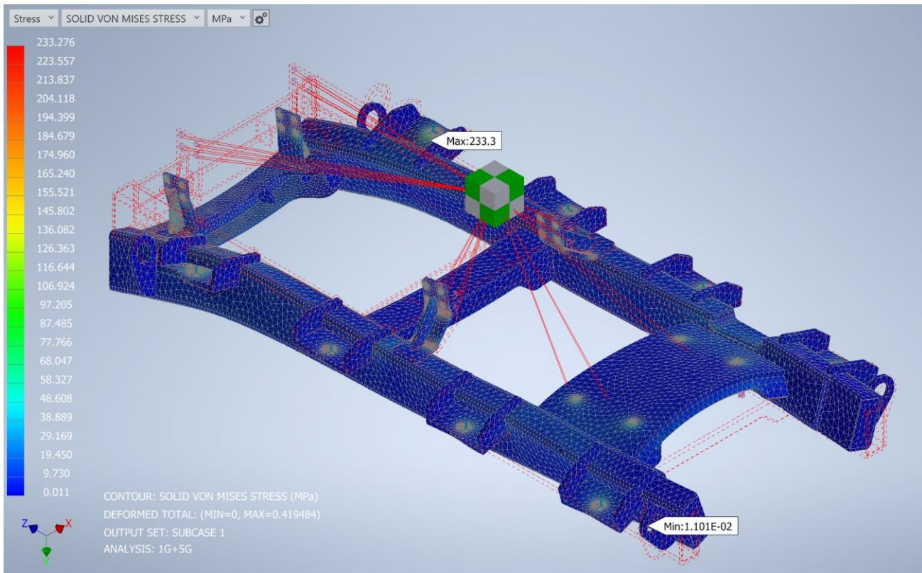
Slika 23. Raspodjela naprezanja u nosaču uslijed inercijske sile u pozitivnom smjeru osi  $z$  (5G)
