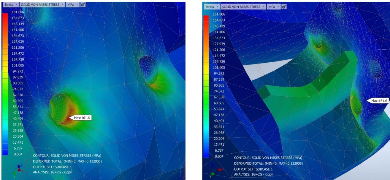
Slika 34. Koncentracije naprezanja za slučaj opterećenja silom inercije u negativnom smjeru osi x (-2G)
