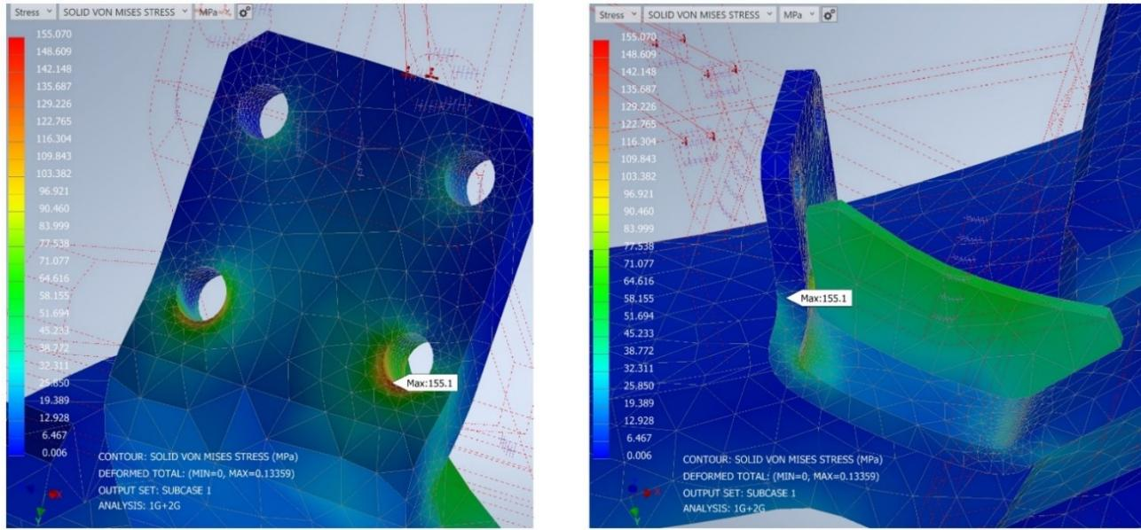
Slika 33. Koncentracije naprezanja za slučaj opterećenja silom inercije u pozitivnom smjeru osi x (2G)
