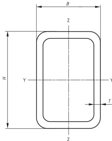
Slika 9. Poprečni presjek profila DIN 10210 – 2 prema [8]
