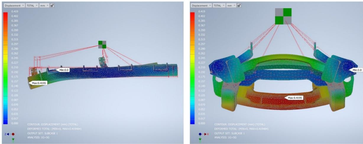
Slika 28. Raspodjela pomaka u nosaču za slučaj opterećenja silom inercije u pozitivnom smjeru osi z (5G) u nacrtu i bokocrtu
