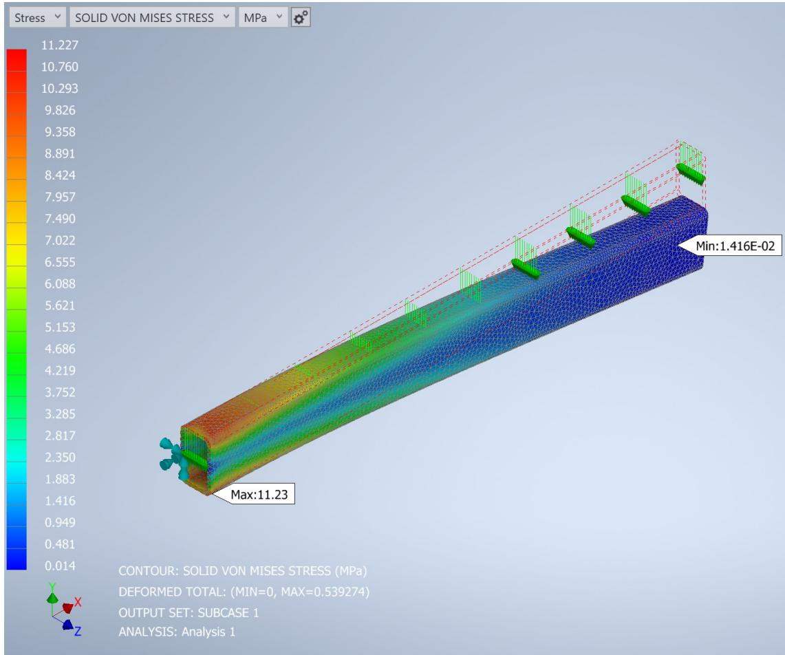
Slika 14. Raspodjela naprezanja po dužini nosača
