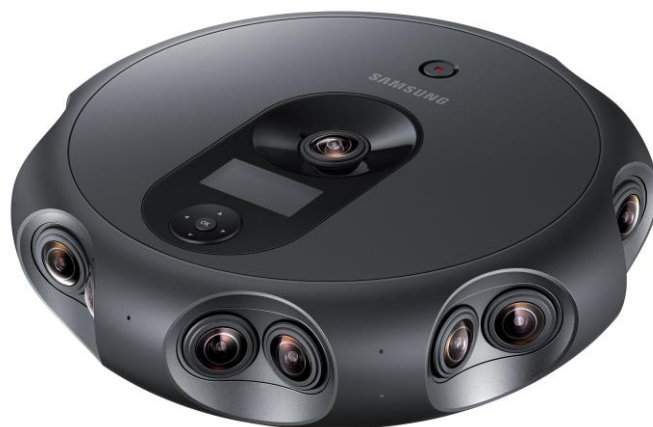
Slika 29. Samsungova 360° kamera za VR [25]
