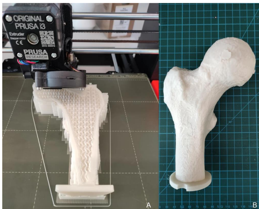
Slika 2.2. Proces tiskanja (A) i konačni primjer 3D tiskane kosti (B) [2]
