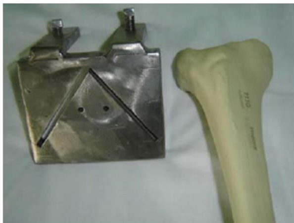
Slika 5.3. Vodič ploča za stvaranje prijeloma tibijalnog platoa in vitro [14]
