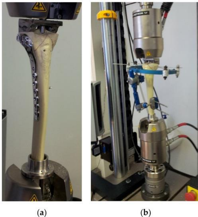
Slika 5.7. Ispitni sklop - a) PLS i b) HEF [14]
