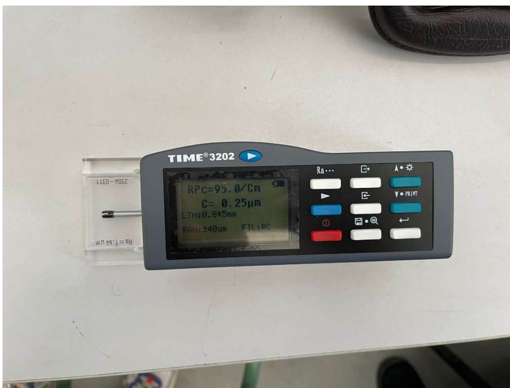
Slika 40: Provjera točnosti uređaja sa etalonom hrapavosti
