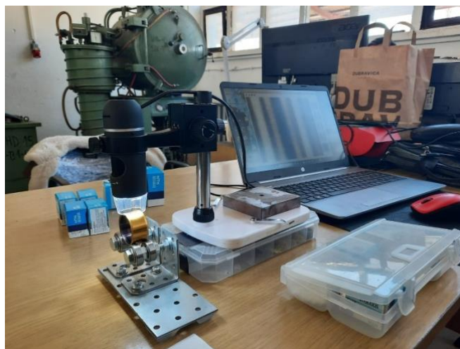
Slika 33. Analiza površine uzoraka primjenom svjetlosnog mikroskopa s kamerom
