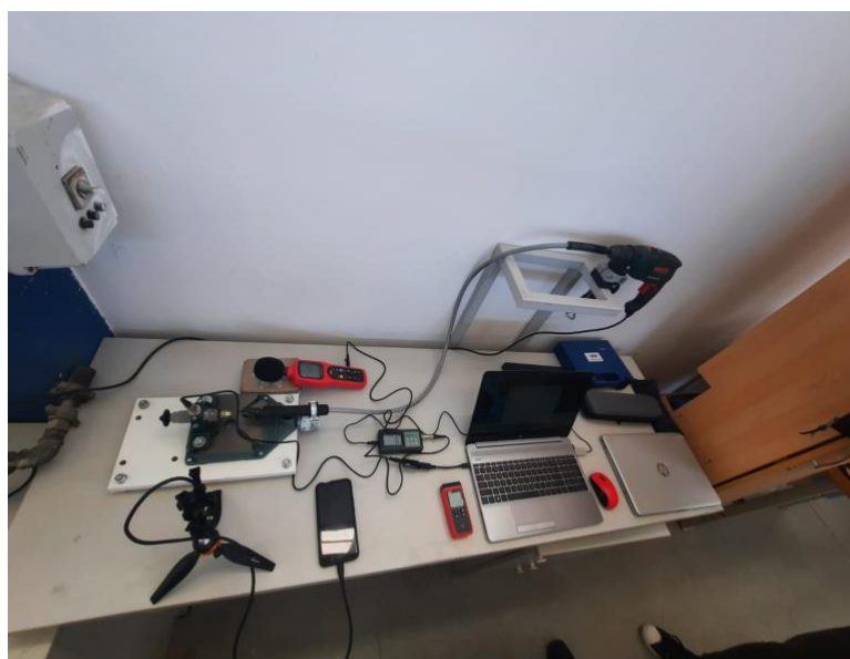
Slika 17. Mjerni postav za ispitivanje vibracija igličastih ležaja
