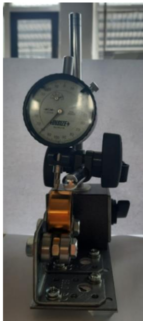
Slika 10. Uređaj za mjerenje odstupanja prstena od kružnosti
