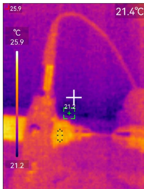
Slika 52. Prsten PN 450/6h fotografiran termokamerom pri 1500 okr/min
