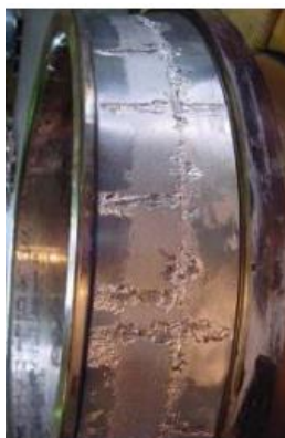
Slika 8. Oštećenja nastala tijekom rada ležaja: umor površine i adhezijsko trošenje [7]
