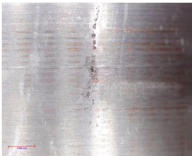
Slika 57. Tragovi trošenja na unutrašnjem prstenu PN 450/6h igličastog ležaja nitriranom u plazmi
