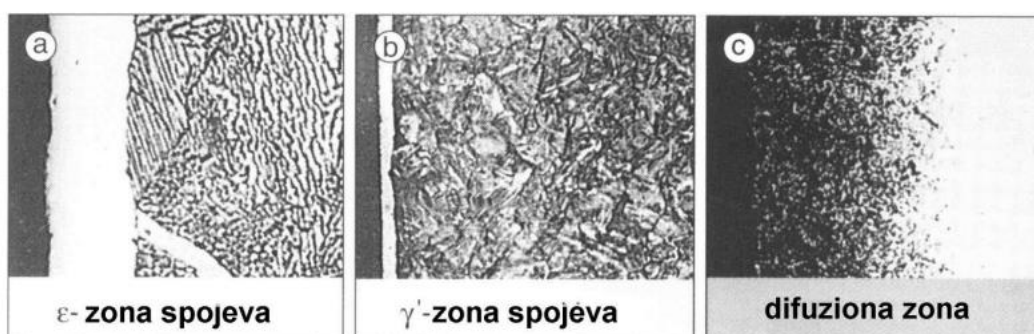
Slika 16. Osnovne strukture zone spojeva nakon nitriranja čelika u plazmi [11]
