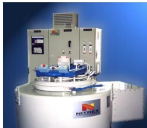
Slika 13. Jamske peći za nitriranje u plinu [11]
