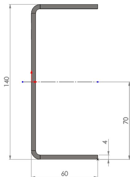
Slika 54. Poprečni presjek profila uzdužnog podkonstrukcije
