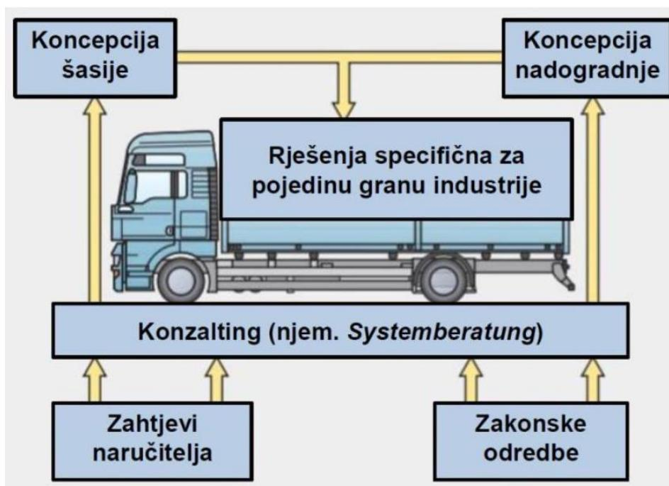
Slika 1. Shematski prikaz koncipiranja nadogradnje teretnog vozila [1]
