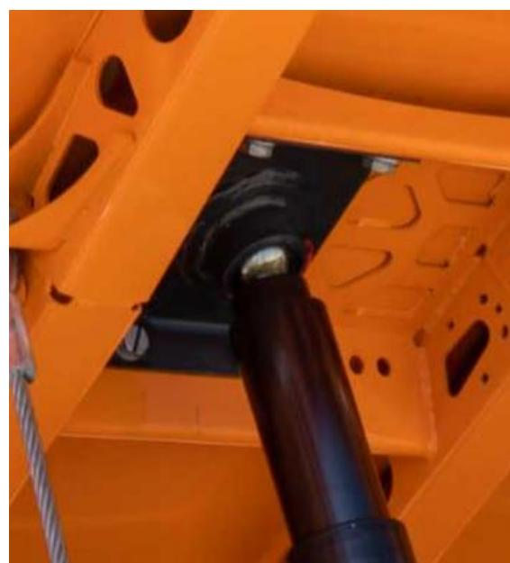
Slika 33. Primjer prihvata hidrauličnog cilindra na tovarni sanduk [10]
