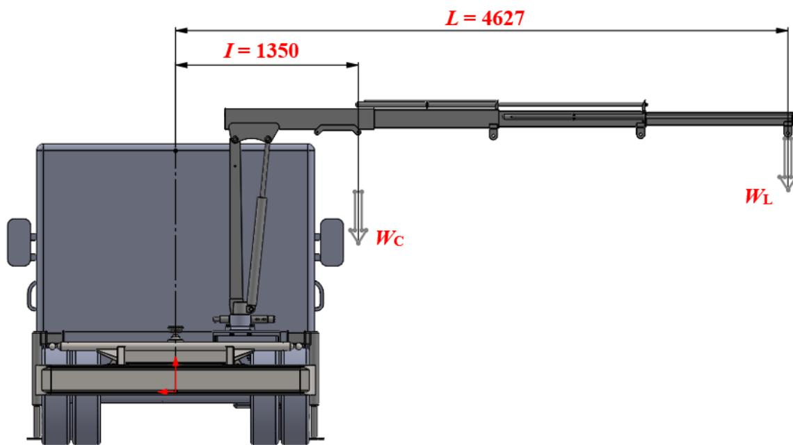
Slika 53. Statički model opterećenja podkonstrukcije prilikom podizanja tereta
