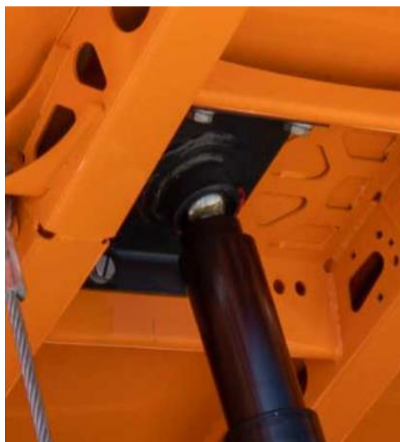
Slika 33. Primjer prihвата hidrauličnog cilindra na tovarni sanduk [10]
