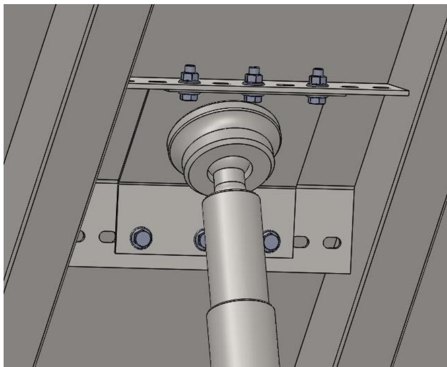
**Slika 34. Prihvata hidrauličkog cilindra na tovarni sanduk**
