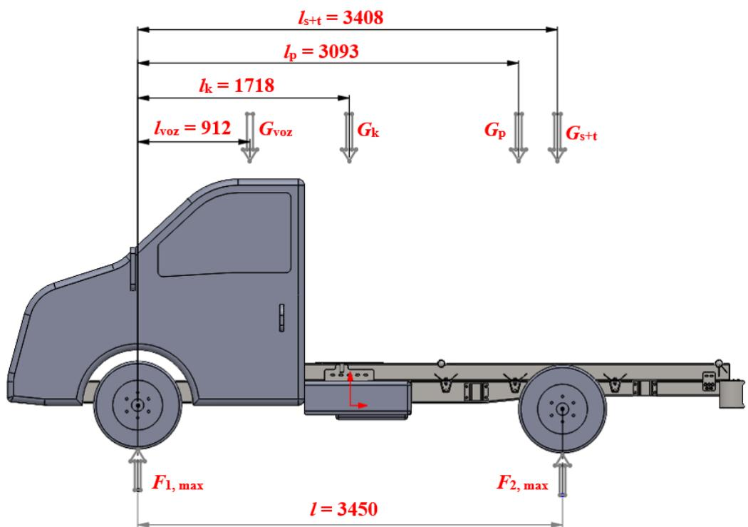
Slika 48. Određivanje maksimalnog osovinskog opterećenja
