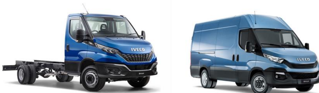
Slika 2. Primjer vozila kategorije N1 - kabina sa šasijom (lijevo) i furgon (desno) [3]
