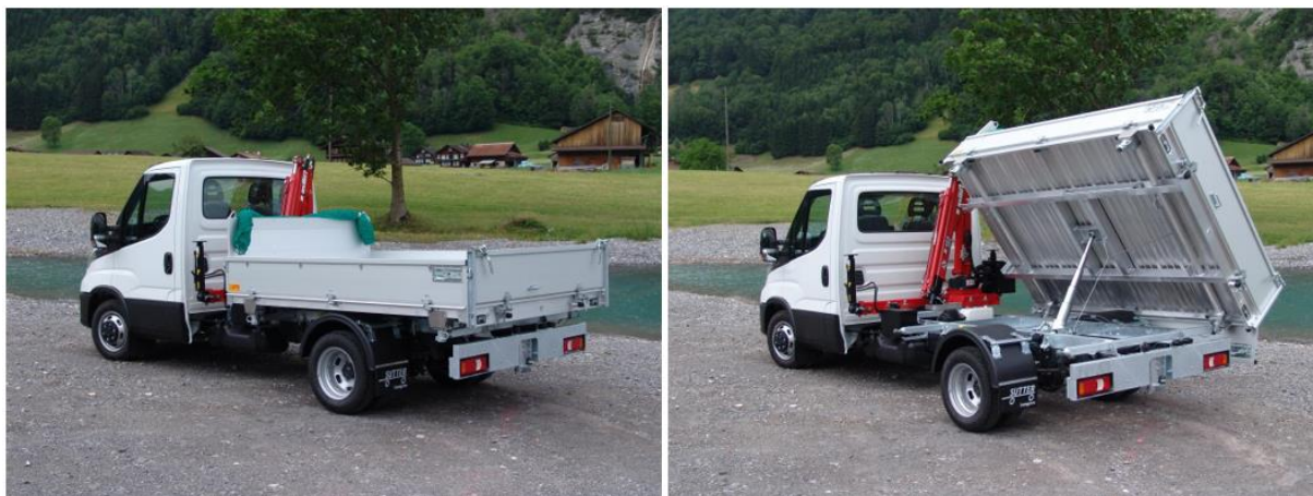
Slika 6. Primjer trostranog kiper s kranskom dizalicom [4]
