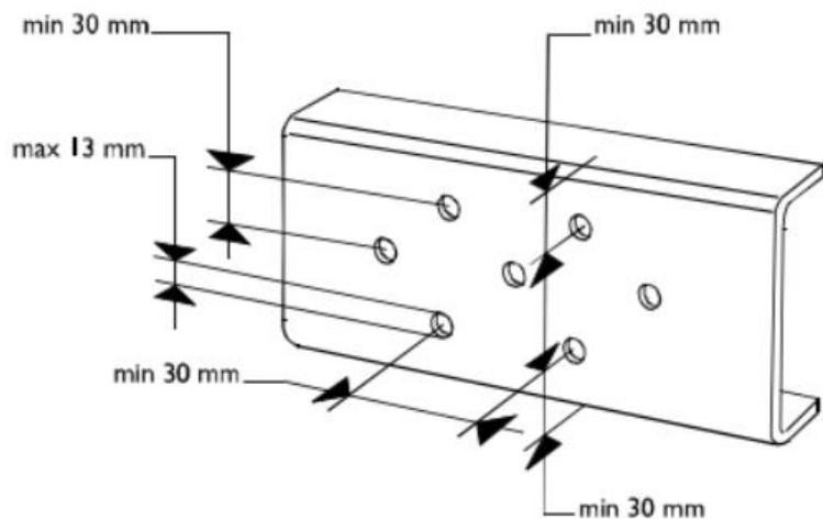
**Slika 21.** Raspored provrta na šasiji vozila [5]
