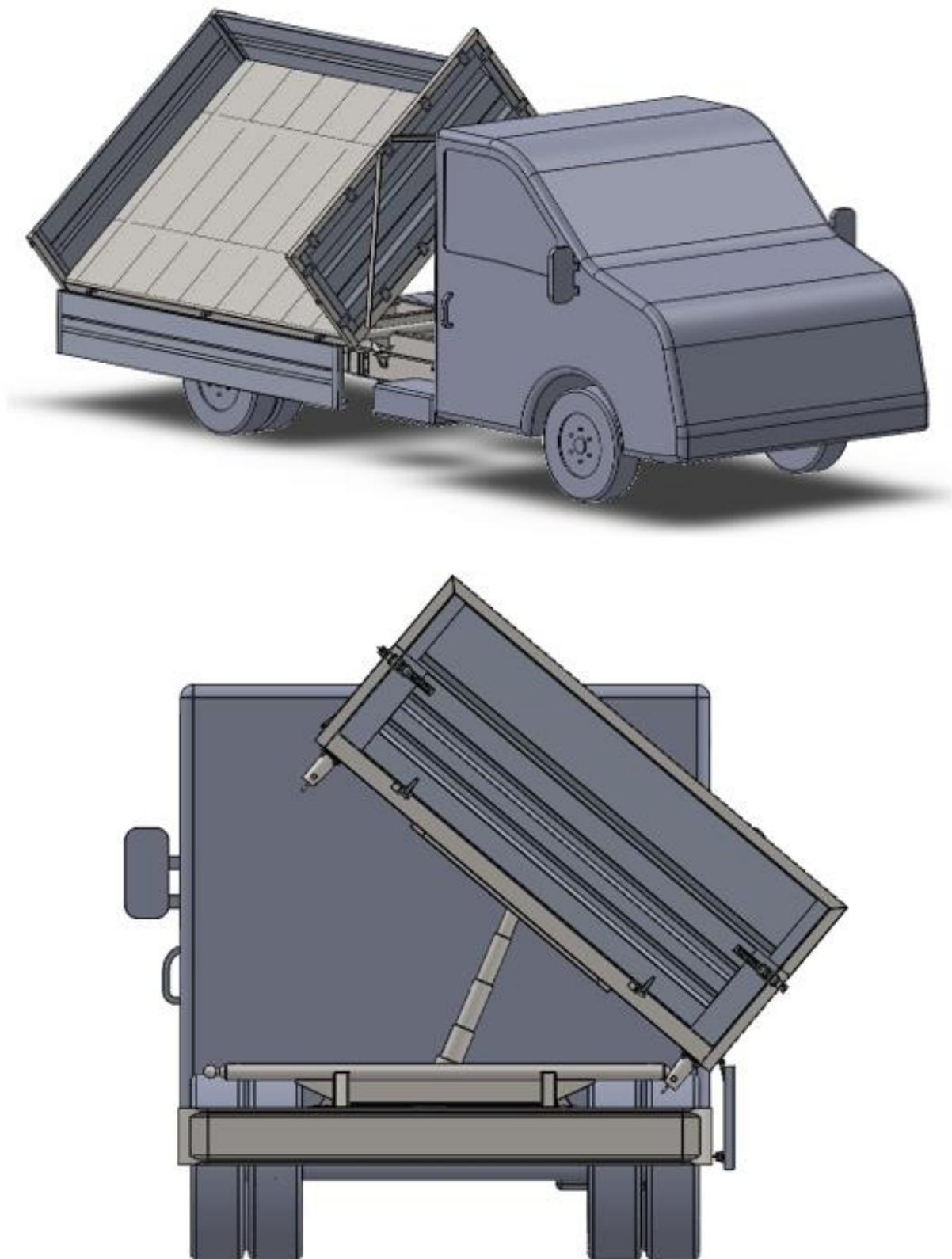
Slika 39. Prikaz bočnog naginjanja tovarnog sanduka
