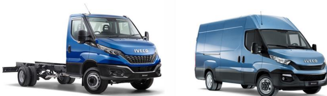
Slika 2. Primjer vozila kategorije N1 - kabina sa šasijom (lijevo) i furgon (desno) [3]
