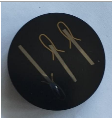
Slika 34. Uzorci boriranog čelika X5CrNiMo17-12-2 pripremljeni za metalografsku analizu
