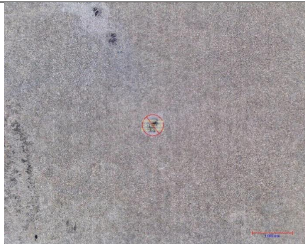
Slika 39. Kalota na uzorku B21 trošenom 10 s
