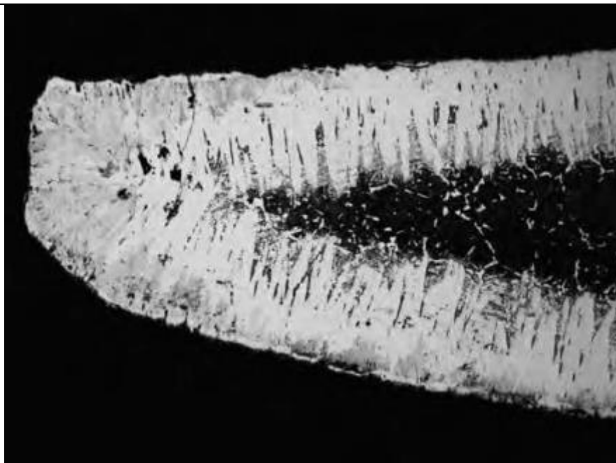
Slika 6. Nastanak FeB faze na vrhu oštrice alata [9]
