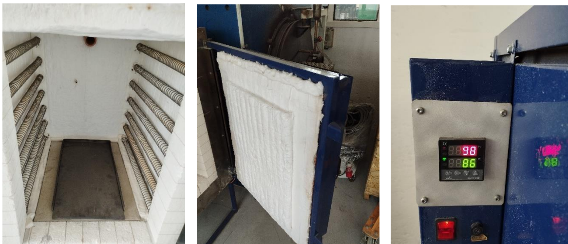
Slika 24. Elektrootporna peć s automatskom regulacijom temperature
