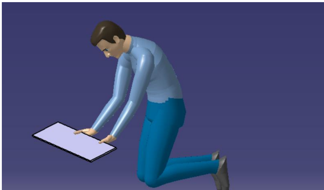
Slika 22. Najnepovoljniji položaj pri postavljanju panela
