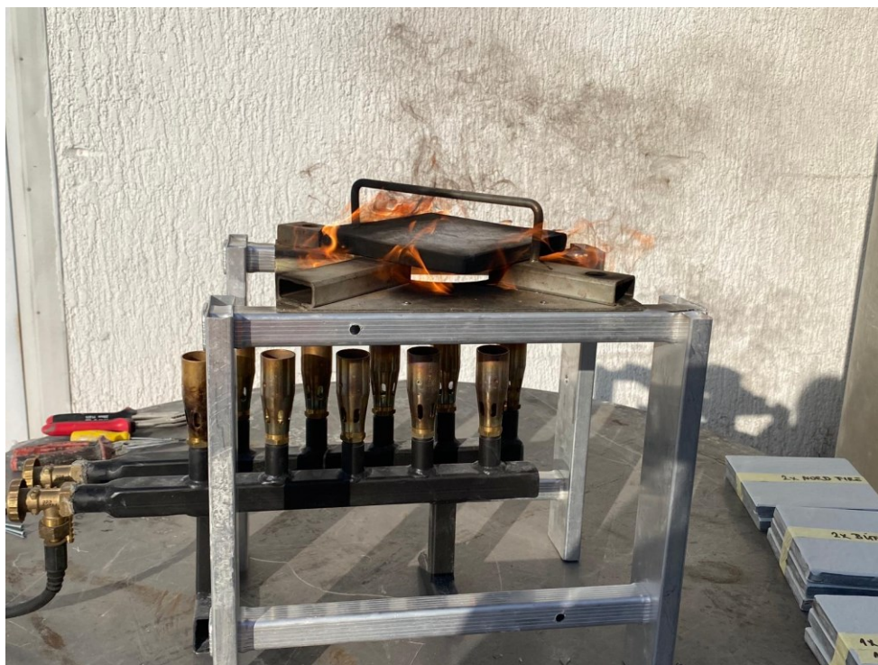
Slika 13. Ispitni uzorak U1 nakon 5 minuta izlaganja
