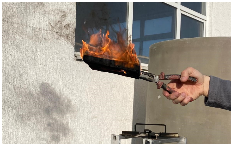
Slika 18. Uzorak U2 nakon uklanjanja sa plamena
