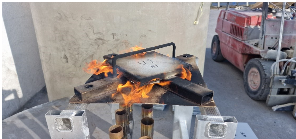
Slika 17. Uzorak U2 nakon 7 min izlaganja
