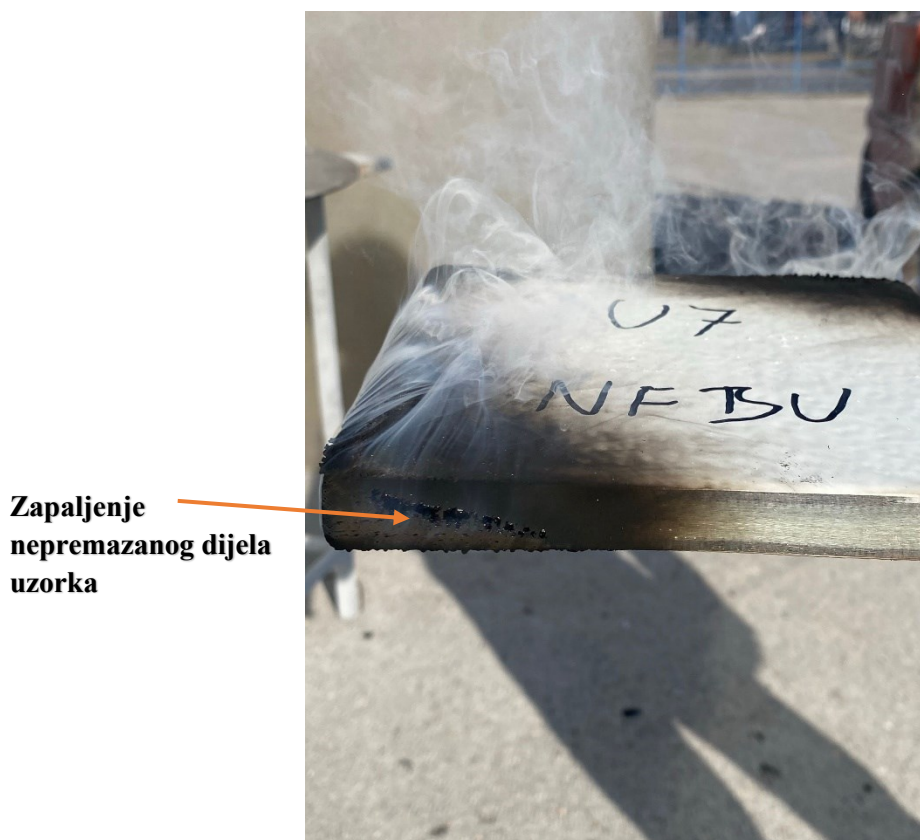
Slika 25. Zapaljenje bočnih stranica uzorka U7
