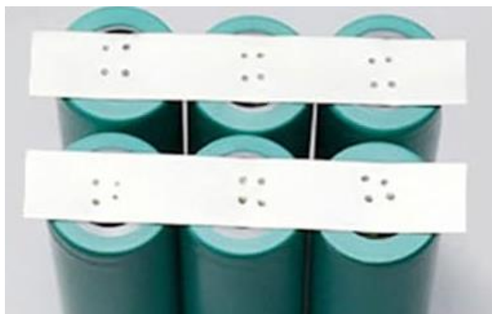
Slika 35 Točkasto zavarene li-ionske ćelije
