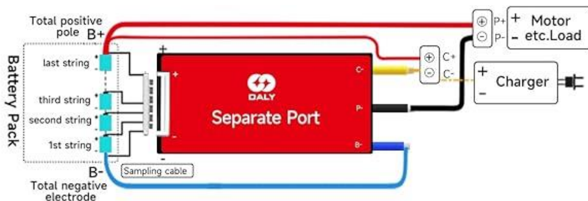
Slika 36 Način spajanja BMS-a
