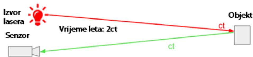
Slika 3. Princip rada TOF metode [5]
