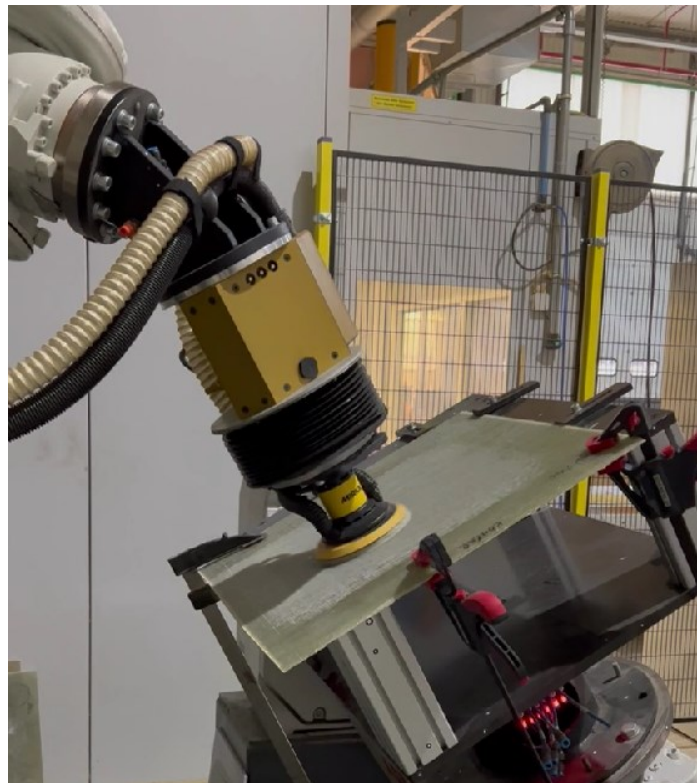
Slika 20. Postupak trošenja brusa
