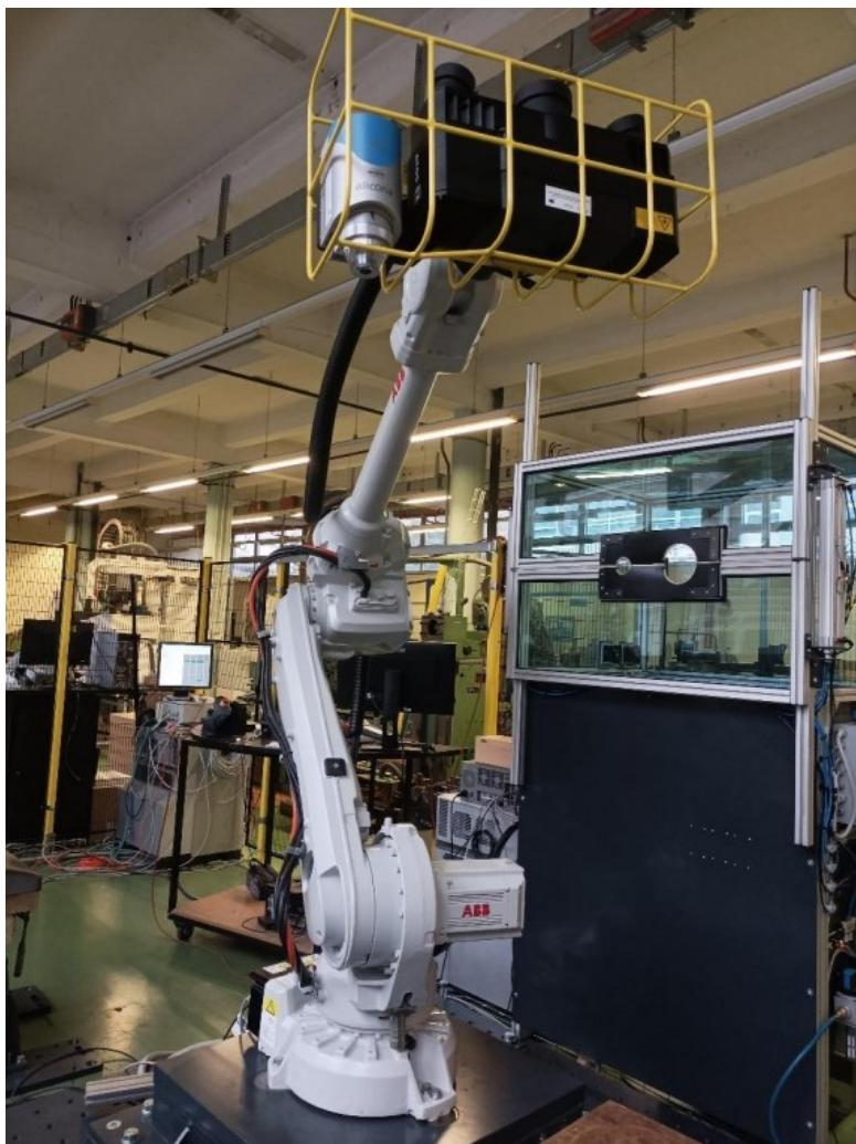
**Slika 12. Mjerni uređaj montiran na prihvatinicu robota**
