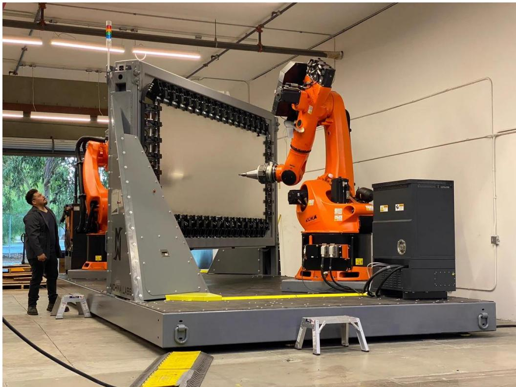
Slika 17. Inkrementalno deformiranje lima pomoću dva robota [13]
