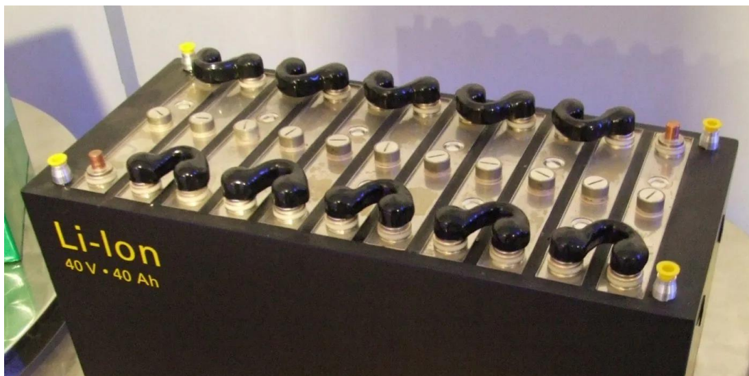
Slika 6. Baterijski sklop (eng. battery pack ) [14]
