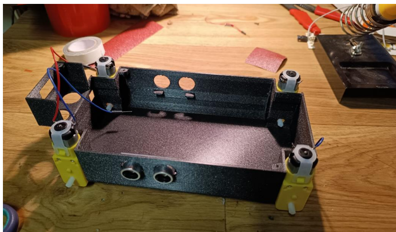
Slika 43. Kućište s postavljenim motorima
