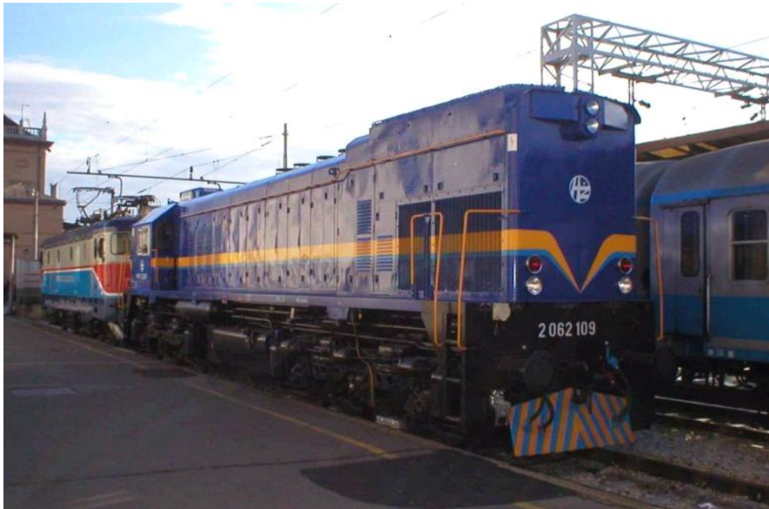
Slika 1. Dizel-električna lokomotiva HŽ serije 2062 100
