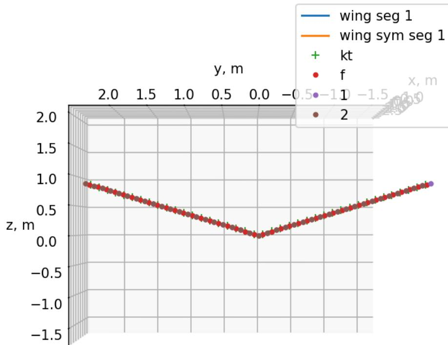
Slika 49. Prikaz geometrije krila sprijeda za maksimizaciju  $C_L/C_D$
