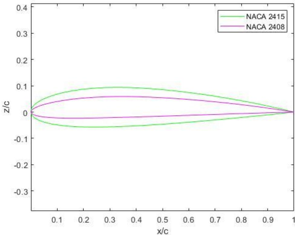
**Slika 20.** Usporedba debljina NACA 2415 i NACA 2408
