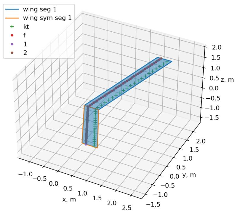
**Slika 47.** Izometrijski prikaz geometrije krila za maksimizaciju  $C_L/C_D$
