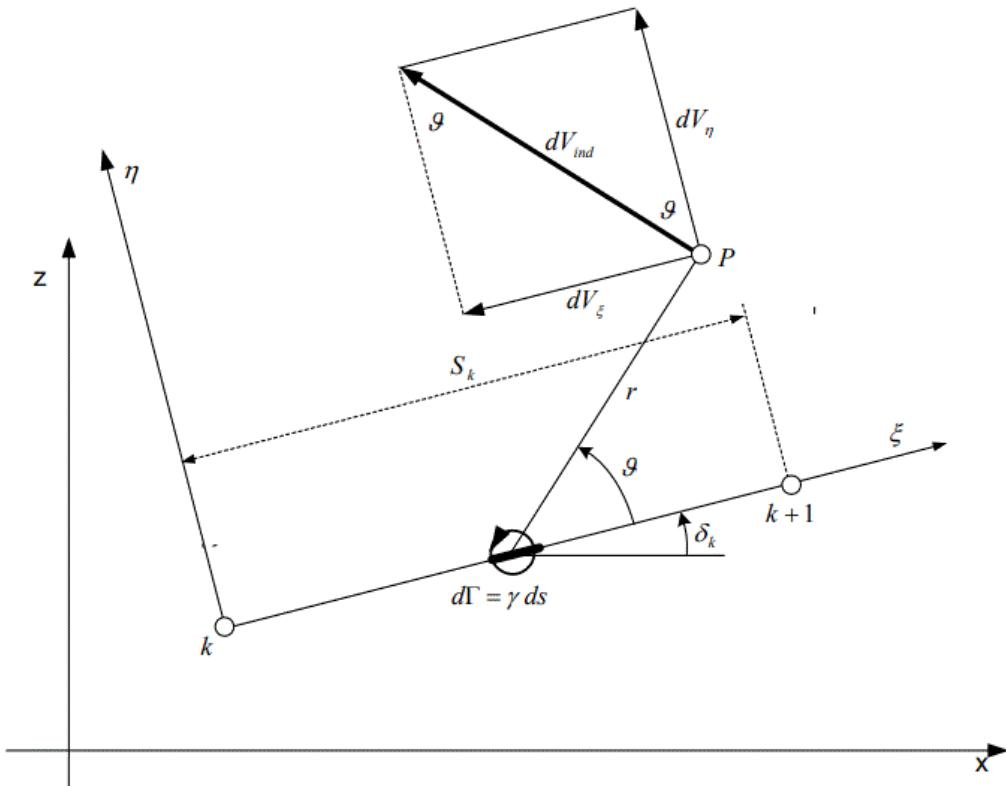
Slika 17. Utjecaj diferencijalnog elementarnog vrtloga na točku P [1]
