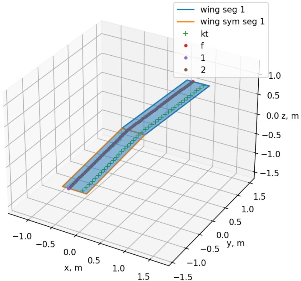
Slika 43. Izometrijski prikaz krila optimalnog projekta  $O_3$
