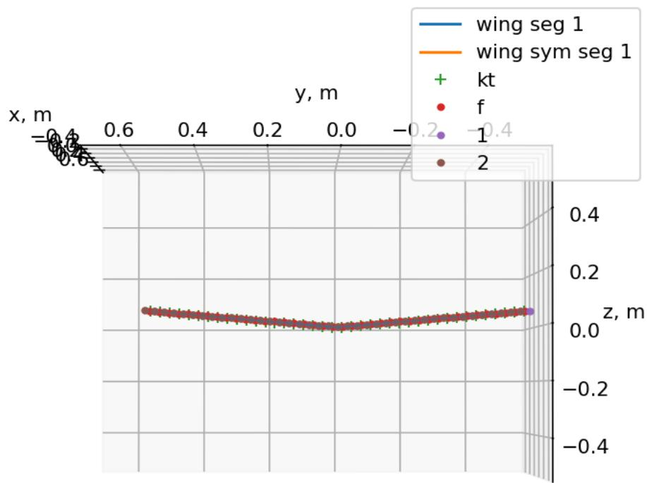
**Slika 46.** Prikaz inicijalne geometrije krila sprijeda za maksimizaciju  $C_L/C_D$
