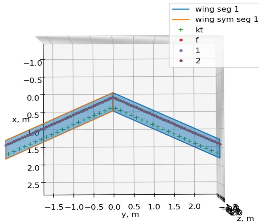
Slika 48. Prikaz geometrije krila odozgo za maksimizaciju  $C_L/C_D$
