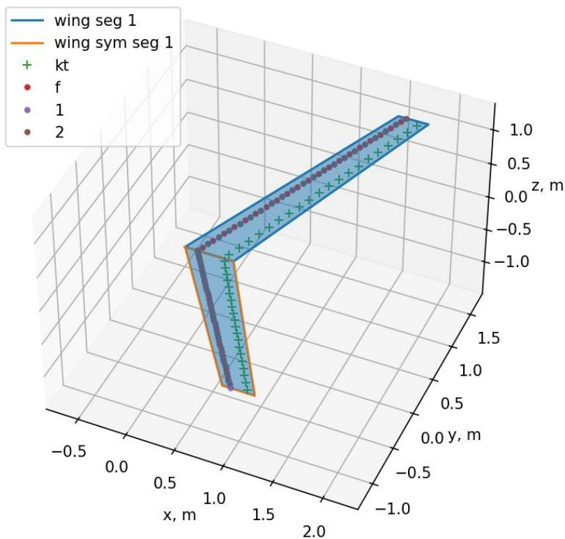
**Slika 39.** Izometrijski prikaz geometrije krila optimalnog projekta  $O_2$
