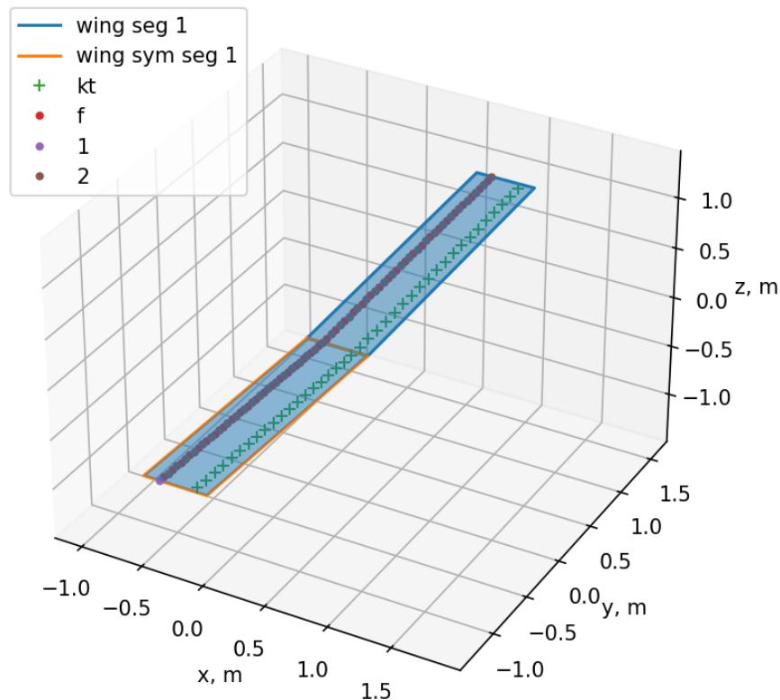
Slika 33. Izometrijski prikaz krila optimalnog rješenja  $O_1$
