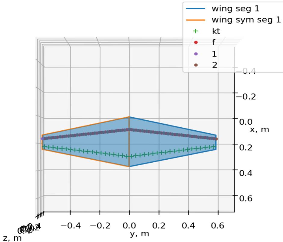
**Slika 45.** Prikaz inicijalne geometrije krila odozgo za maksimizaciju  $C_L/C_D$
