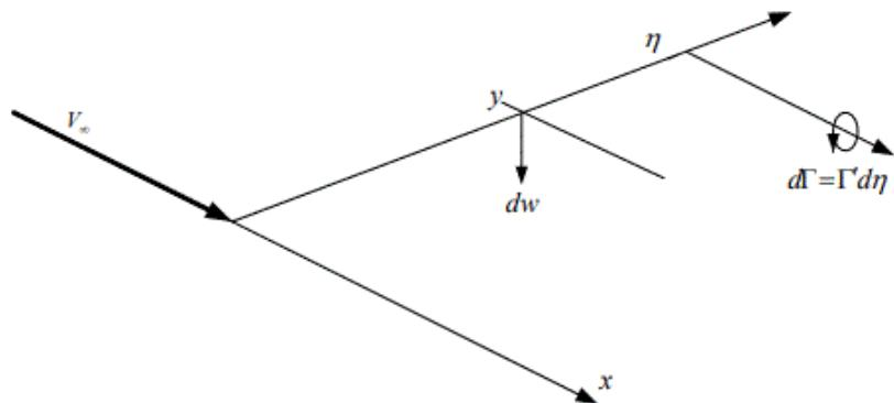
Slika 10. Inducirana brzina i položaj vrtložne niti  $d\Gamma$  [1]
