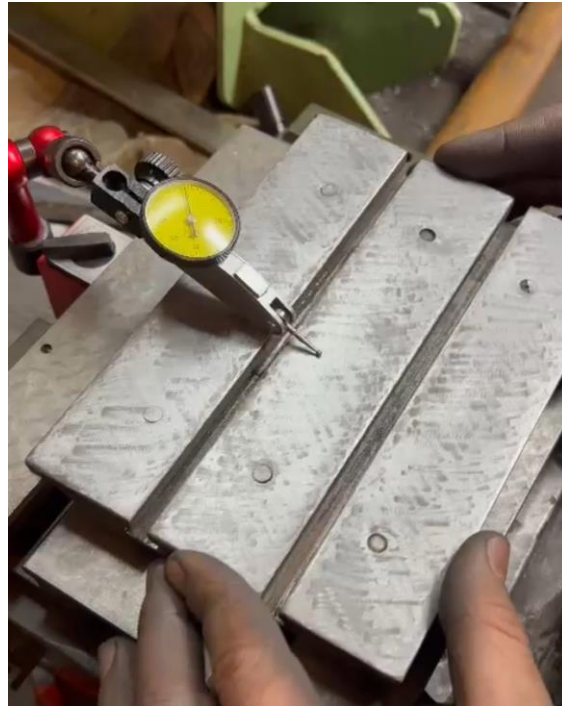
Slika 32. Ispitivanje ravnosti i paralelnosti stola s T utorima
