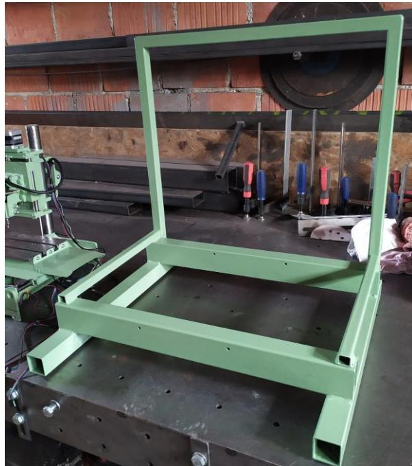
Slika 39. Cijevna zavarena konstrukcija kućišta glodalice
