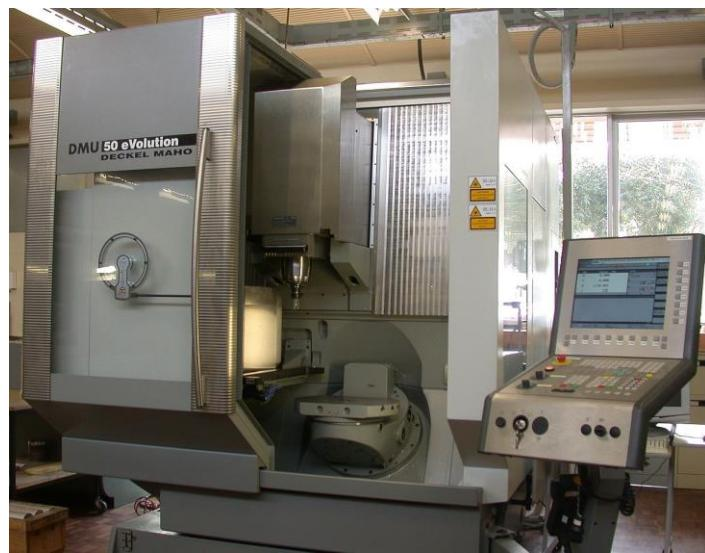
Slika 3. Glodaći obradni centar pet-osni [2]
