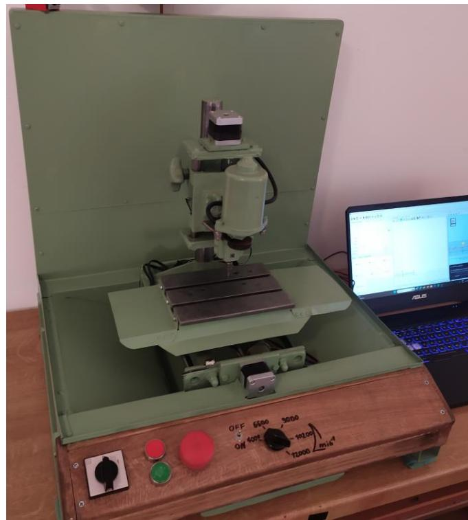
Slika 40. Stvarni izgled sklopa kućišta i glodalice
