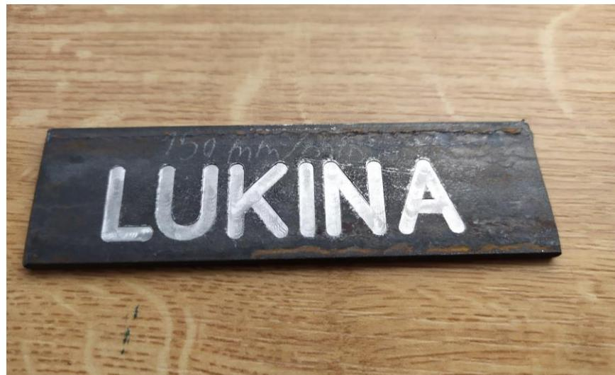
Slika 56. Gravirani natpis na čeličnom izratku, dubina 0,15 mm
