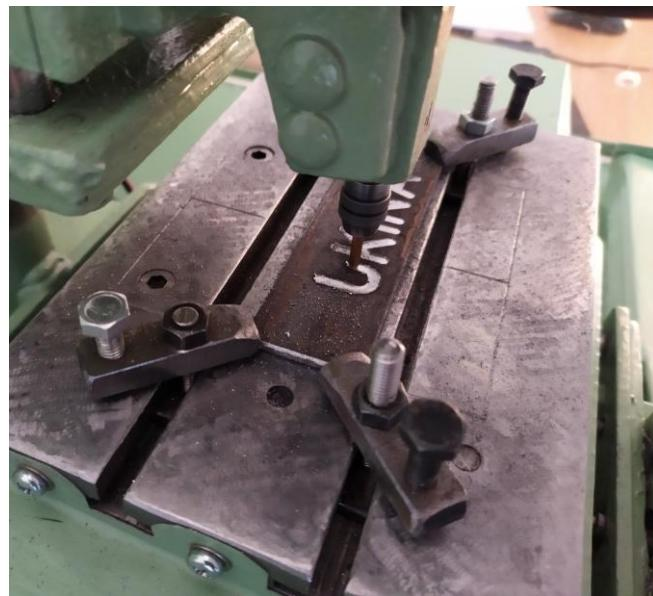
Slika 54. Graviranje čeličnog obratka
