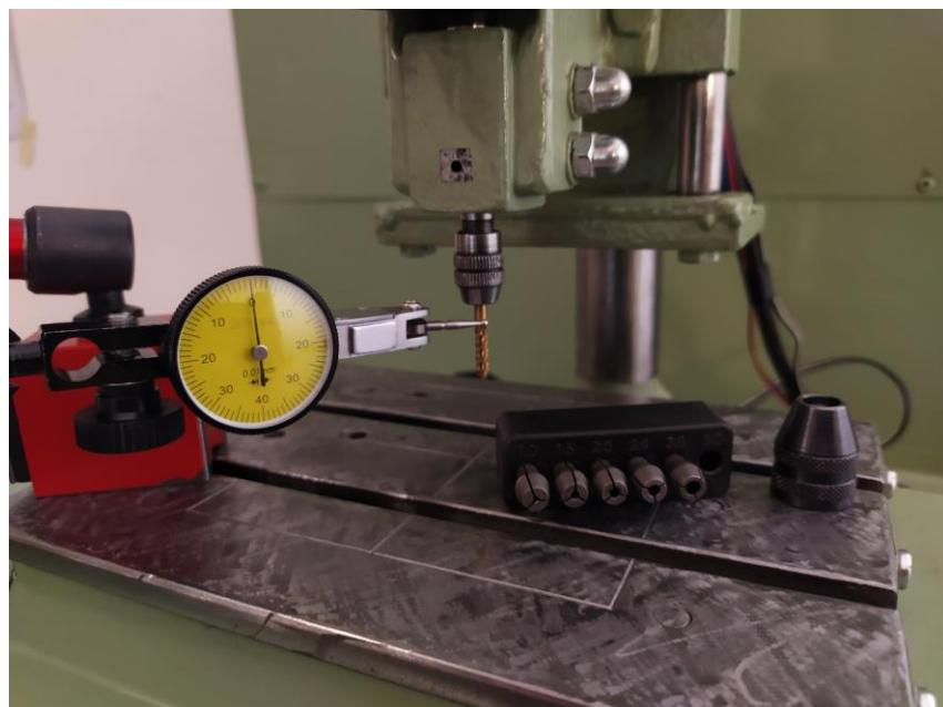
Slika 22. Set Proxxon steznih čahura, brzostezna glava i način mjerjenja ekscentričnosti
