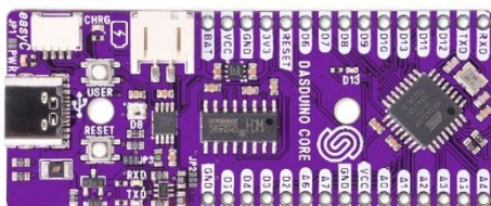
Slika 15. Atmega328P na Dasduino Core pločici
