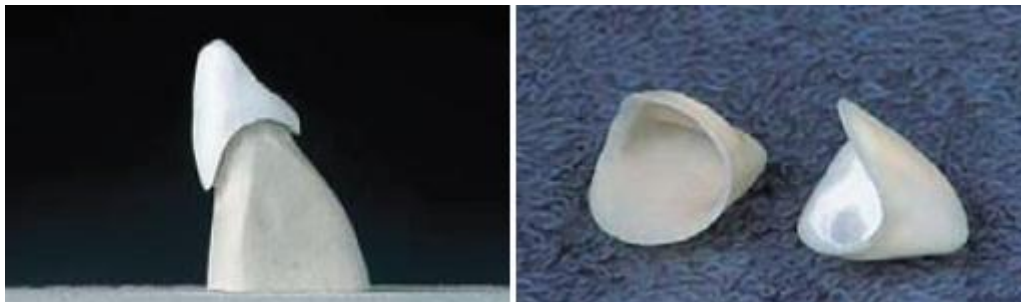
Slika 8. Zubna navlaka a) prije sinteriranja b) nakon sinteriranja [5]
