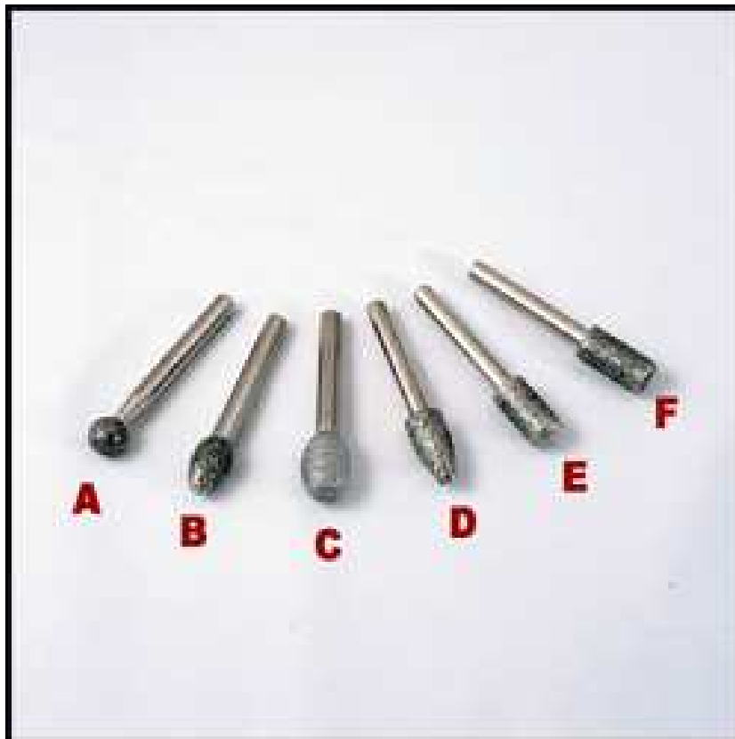
Slika 8. Galvanizirani alati za obradu kamena [ 6 ]
