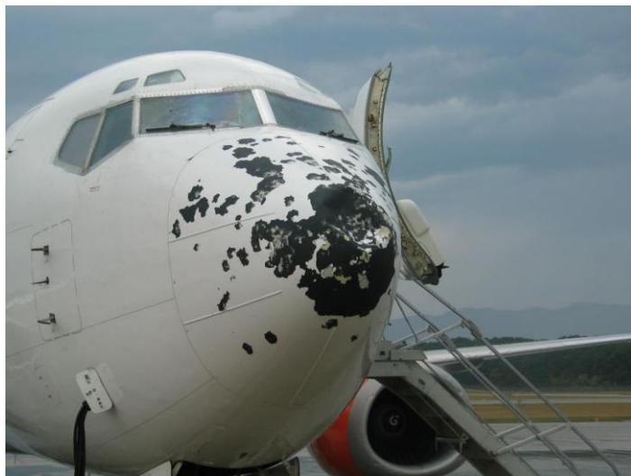
Slika 15 - Udarne oštećenja uslijed tuče
