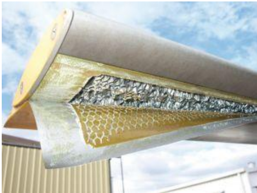
Slika 11 – Delaminacija na rotorskoj lopatici helikoptera
