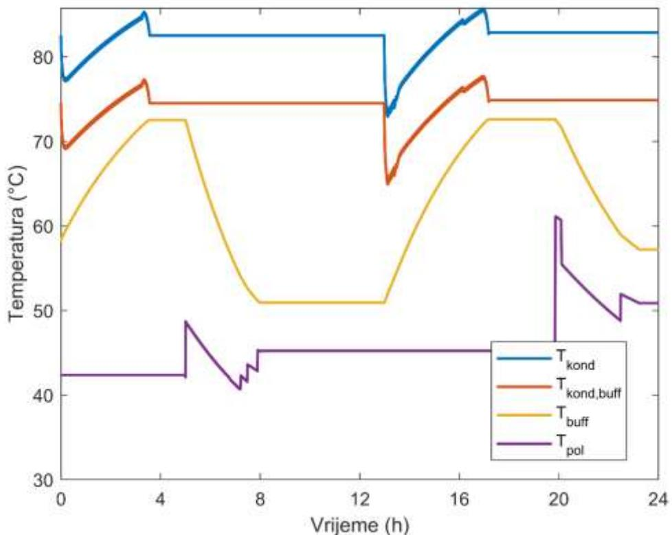
Slika 37. Temperature u podsustavu pufer spremnika uz prediktivno vođenje
