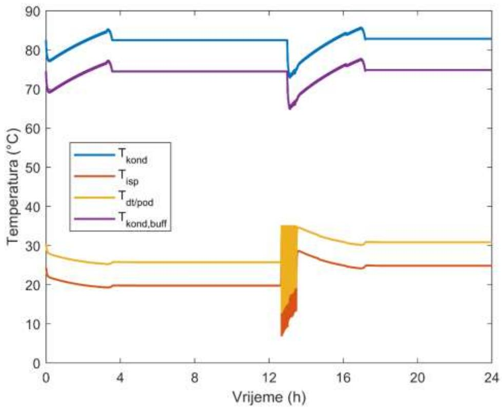
Slika 36. Temperatura isparavanja i kondenzacije u dizalici topline uz prediktivno vodenje
