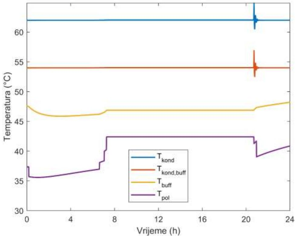
Slika 29. Temperaturе podsustava pufer spremnika za prijelazan dan
