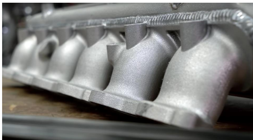
Slika 4.10. Usisni razvodnik od aluminija [34]
