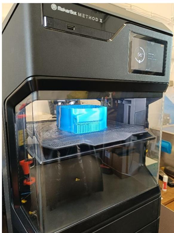
Slika 5.13. Izrada prototipa od ABS-a
