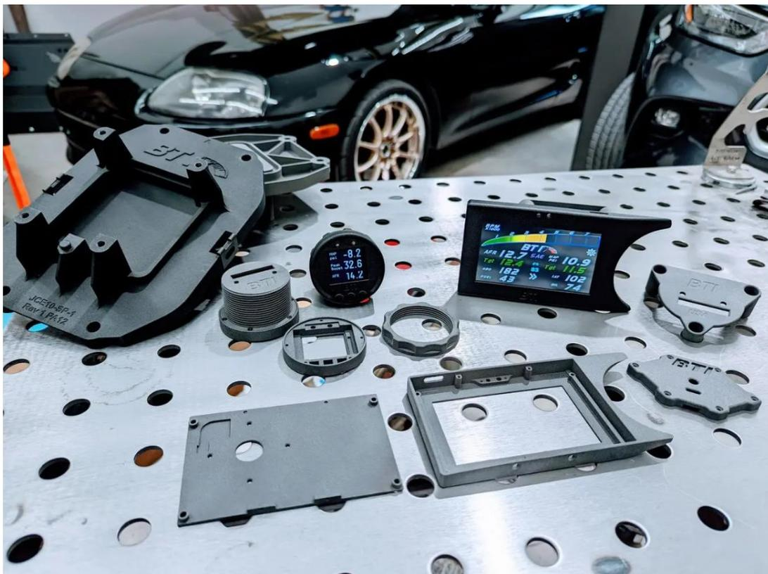
Slika 4.3. Dijelovi zaslona automobila izrađeni AM postupcima [20]
