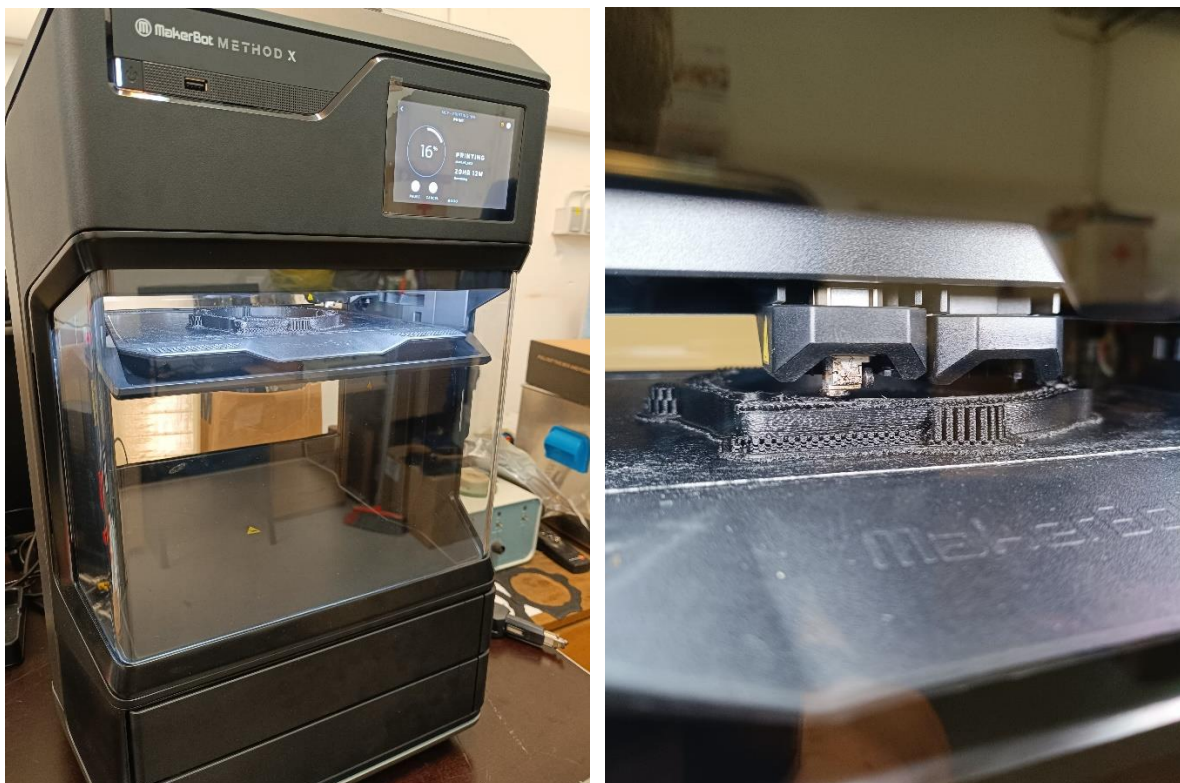
Slika 5.22. Ispis tvorevine od materijala PA 12 ojačanog ugljičnim vlaknima u tijeku
