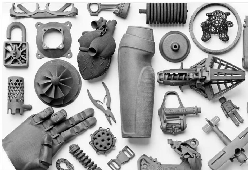
Slika 3.9. Tvorevine od poliamida nastale postupkom selektivnog laserskog srašćivanja [16]
