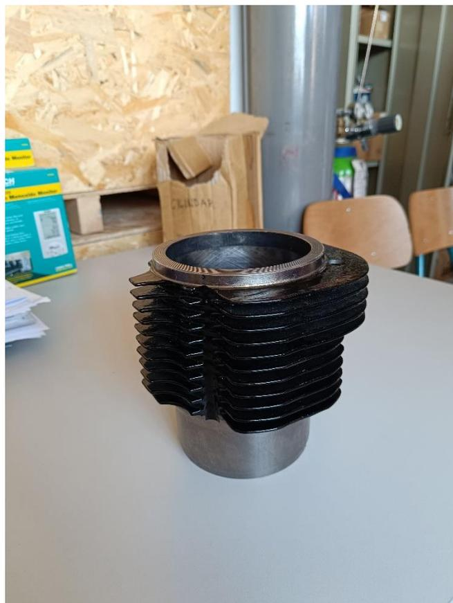
Slika 5.2. Cilindar eksperimentalnog motora
