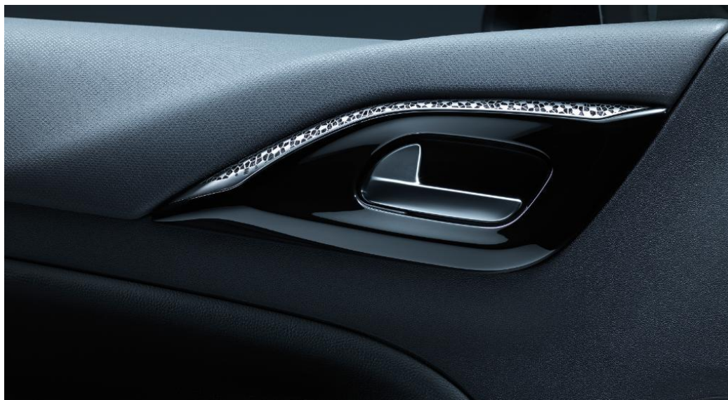
Slika 4.7 Obloga ručke za vrata izrađena aditivnim postupcima [32]
