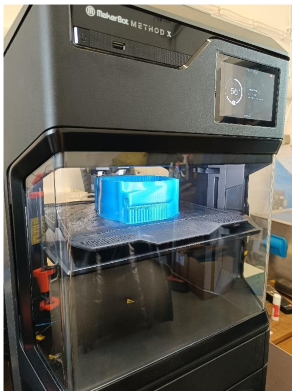
Slika 5.13. Izrada prototipa od ABS-a
