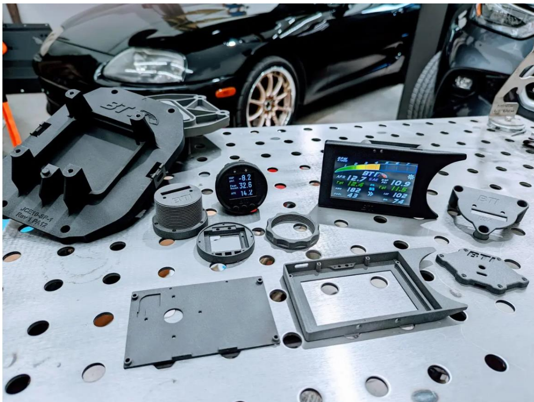
Slika 4.3. Dijelovi zaslona automobila izrađeni AM postupcima [20]
