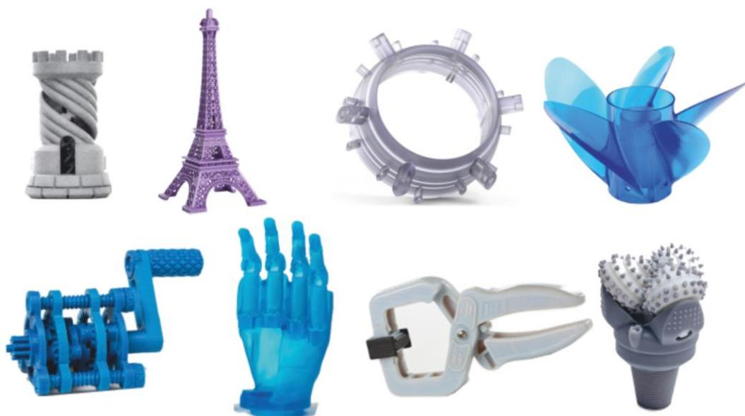
Slika 3.3. Tvorevine načinjene postupkom stereolitografije [10]
