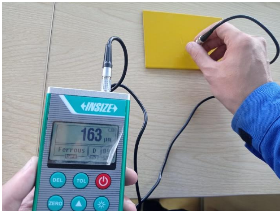
Slika 46. Mjerenje debljine premaza
