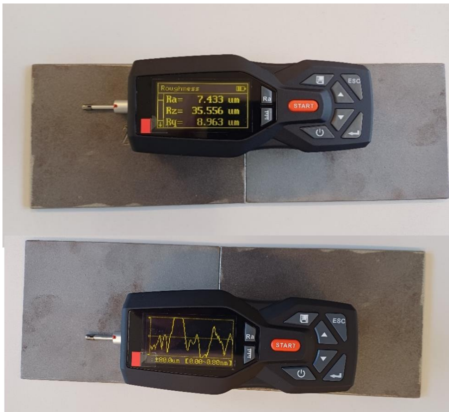
Slika 50. Mjerenje hrapavosti uređajem s pomičnim ticalom
