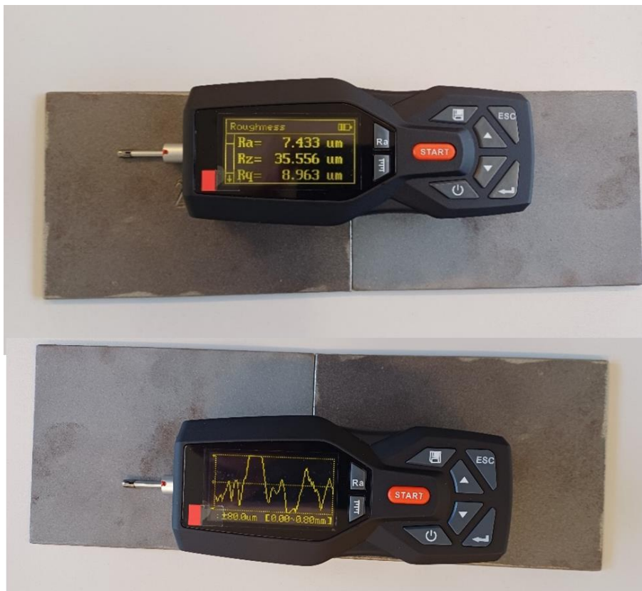
Slika 50. Mjerenje hrapavosti uređajem s pomičnim ticalom
