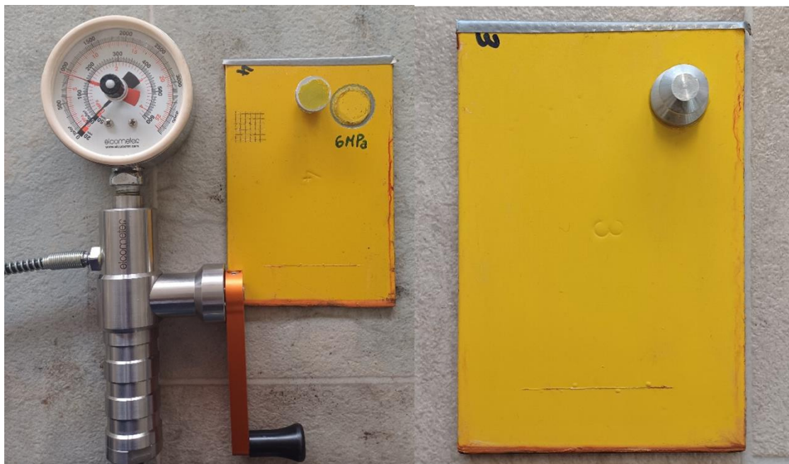
Slika 62. Postupak ispitivanja prionjivosti vlačnom metodom
