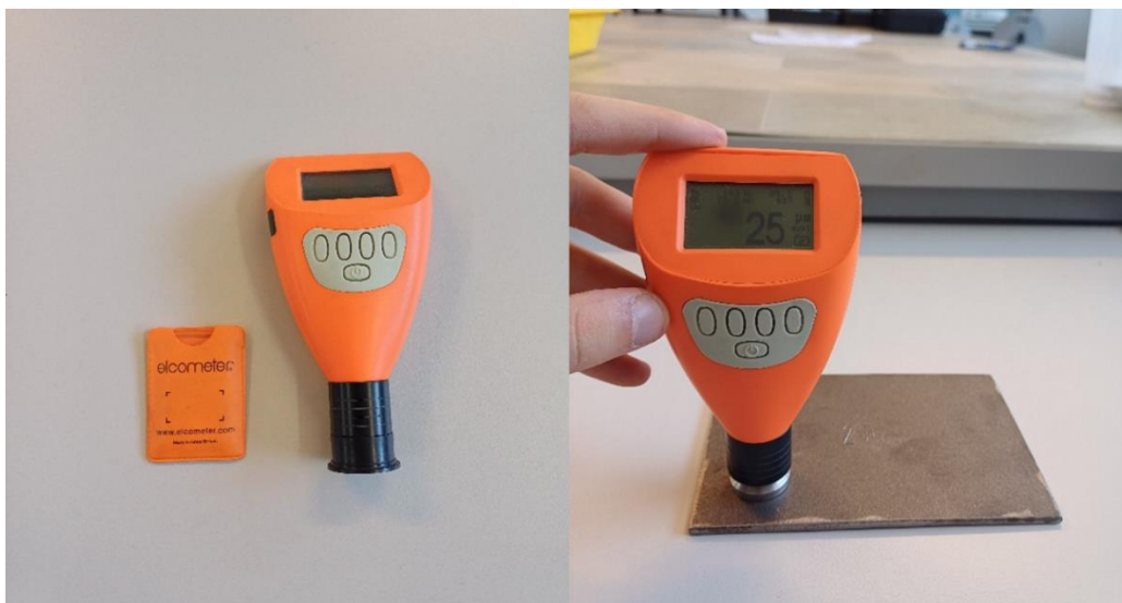
Slika 49. Mjerenje hrapavosti uređajem „Elcometer 224“
