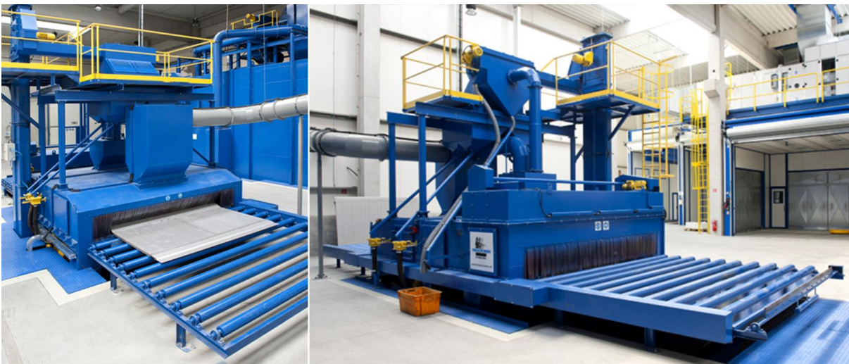
Slika 25. Postrojenje za sačmarenje [41]
