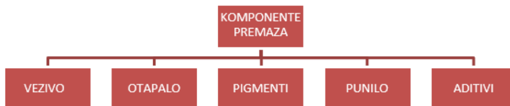
Slika 11. Komponente organskih premaza
