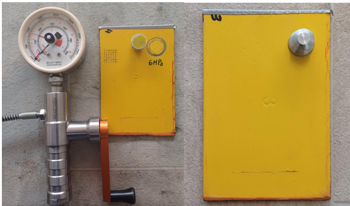
Slika 62. Postupak ispitivanja prionjivosti vlačnom metodom
