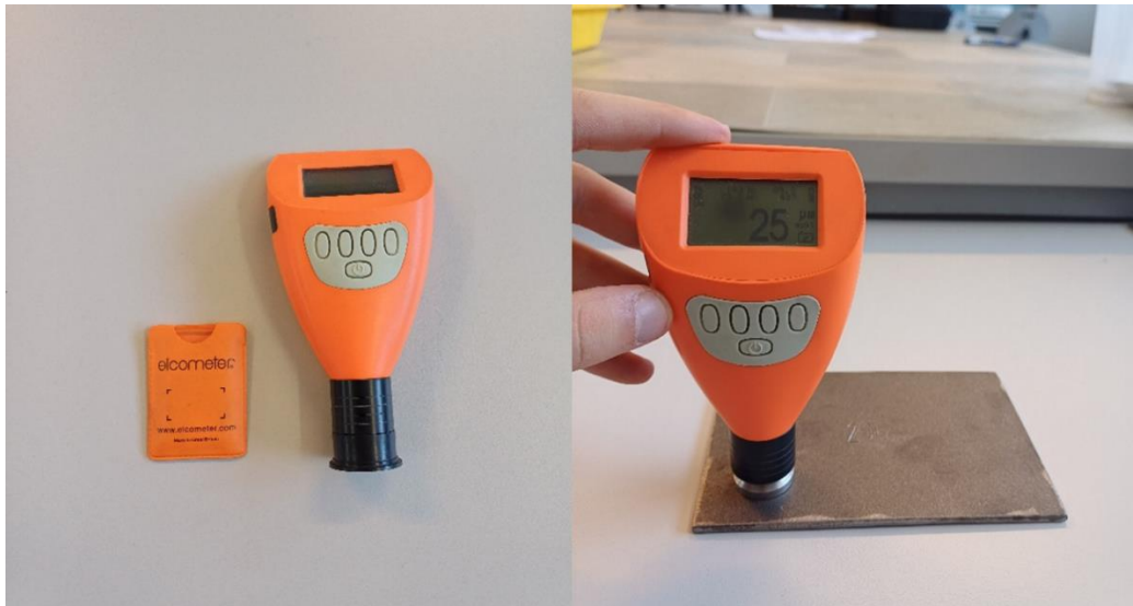
Slika 49. Mjerenje hrapavosti uređajem „Elcometer 224“
