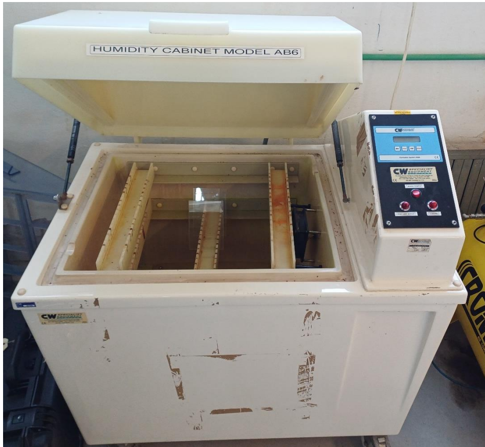
Slika 55. Vlažna komora „Humidity Cabinet Model AB6“, Fakultet strojarstva i brodogradnje, Laboratorij za zaštitu materijala
