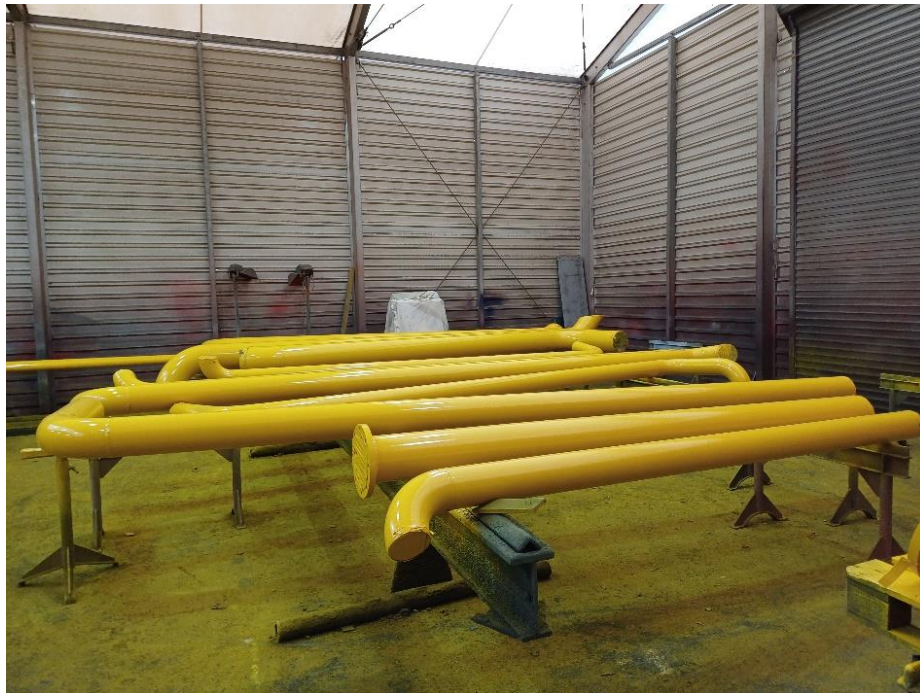
Slika 37. Cijevni elementi premazani u lakirnici
