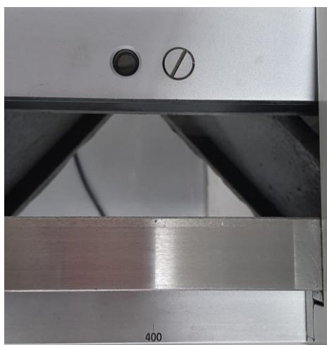
Slika 4.9 Numerička vrijednost velike mjerne skale (dolje) i optički prozorčić (gore)
