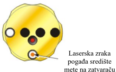
Slika 5.3 Laserska zraka odbijena od mjernog reflektora nazad na zatvarač [2]
