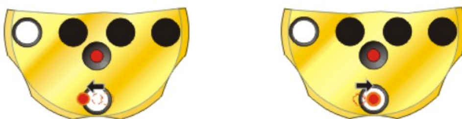
Slika 5.9 Horizontalno podešavanje snopa [2]
