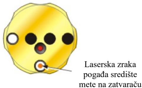
**Slika 5.3 Laserska zraka odbijena od mjernog reflektora nazad na zatvarač [2]**
