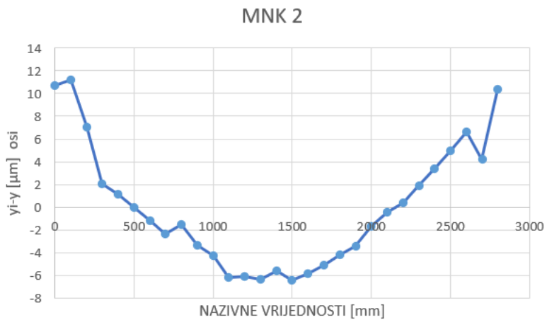
Slika 73. Odstupanje drugog mjerenja od vertikalne pravocrtnosti
