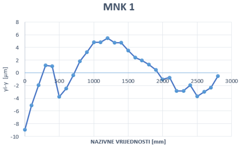
Slika 59. Odstupanje prvog mjerenja od horizontalne pravocrtnosti
