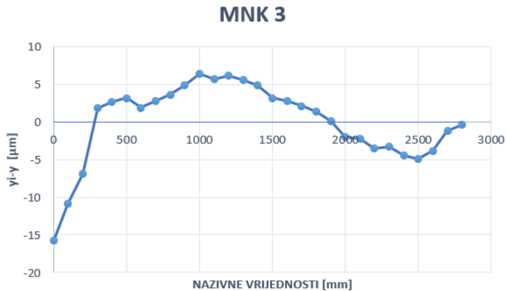
Slika 61. Odstupanje trećeg mjerenja od horizontalne pravocrtnosti
