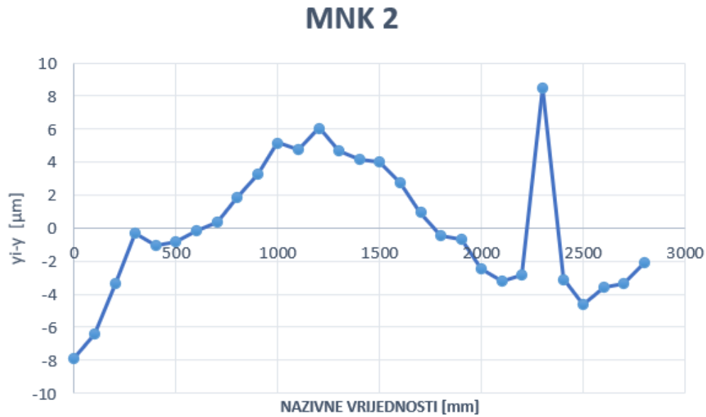
Slika 60. Odstupanje drugog mjerenja od horizontalne pravocrtnosti
