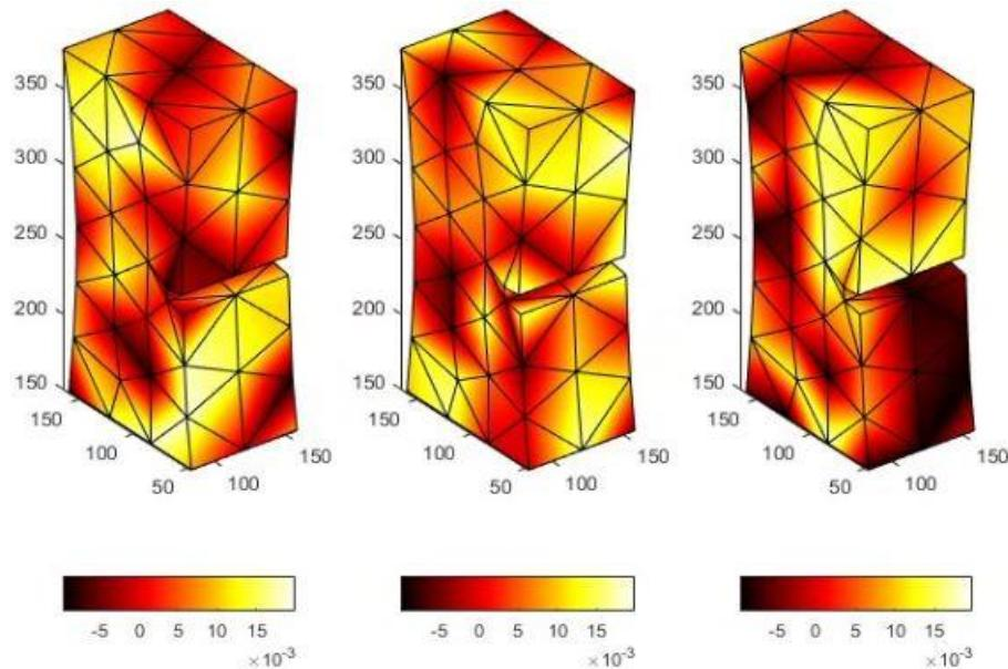
Slika 36. Razlike polja pomaka izmјerenih DVC i P-DVC metodom po a)  $x$ -osi, b)  $y$ -osi i c)  $z$ -osi
