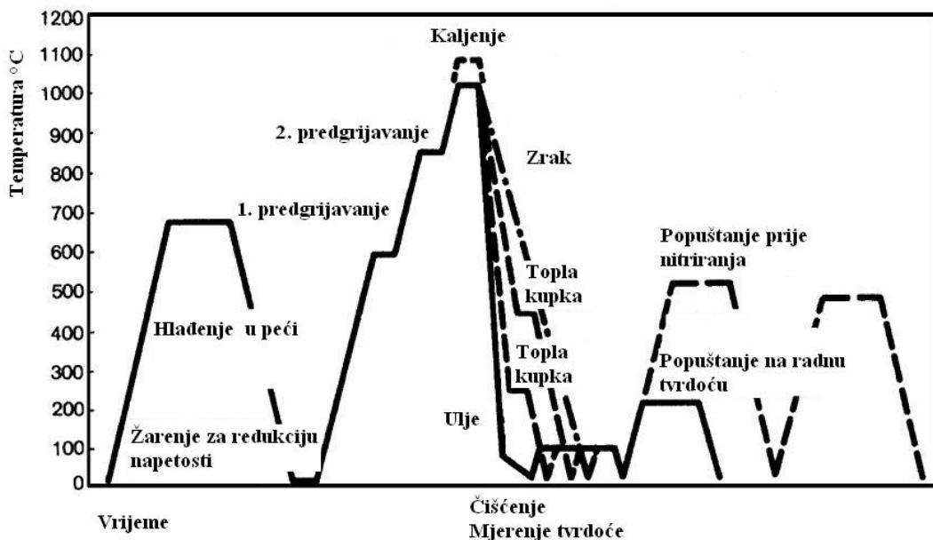
Slika 16. Dijagram toplinske obrade čelika K110 [8]
