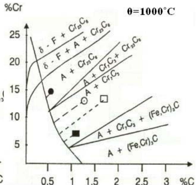
Slika 7. Izotermički presjek stava Fe-Cr-C pri 1000°C [1]
