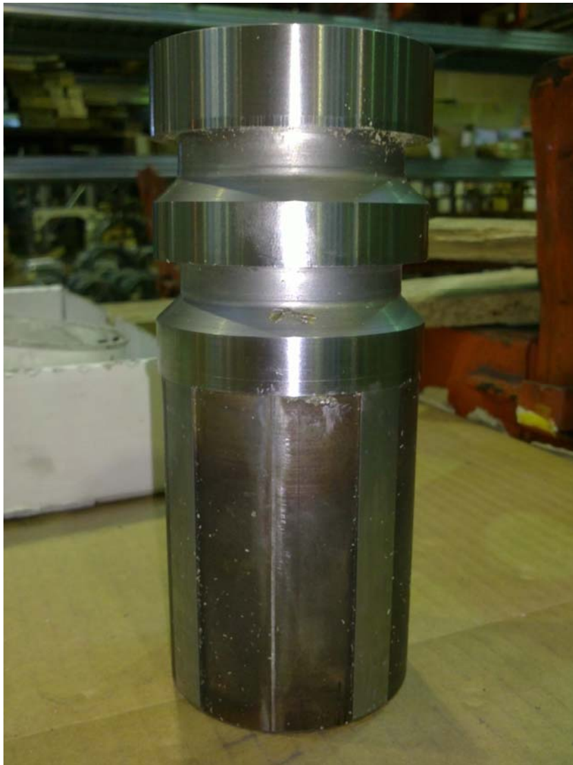
Slika 14. Provlakač rotora generatora 225 izrađen od materijala K110 (X 155 CrVMo 12 1)
