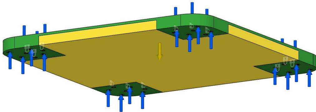
**Slika 4.6 Priprema generativnog dizajna tijela robota**
