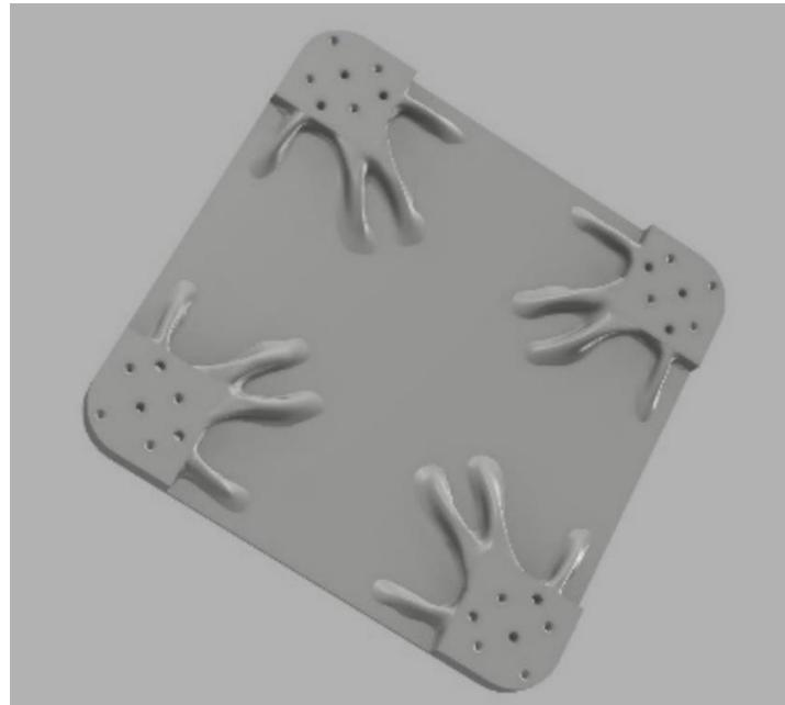
**Slika 4.7 Rezultat generativnog dizajna tijela robota**
