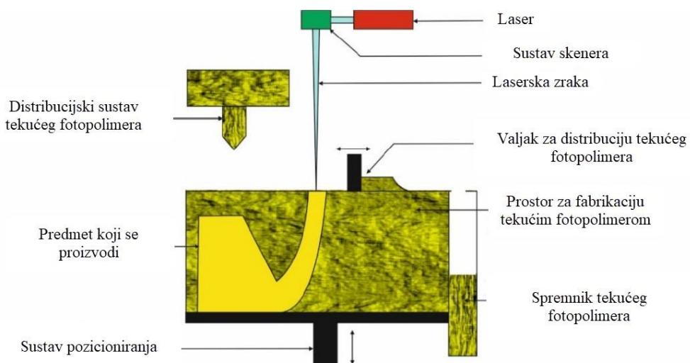
Slika 3.2 Stereolitografija [8]
