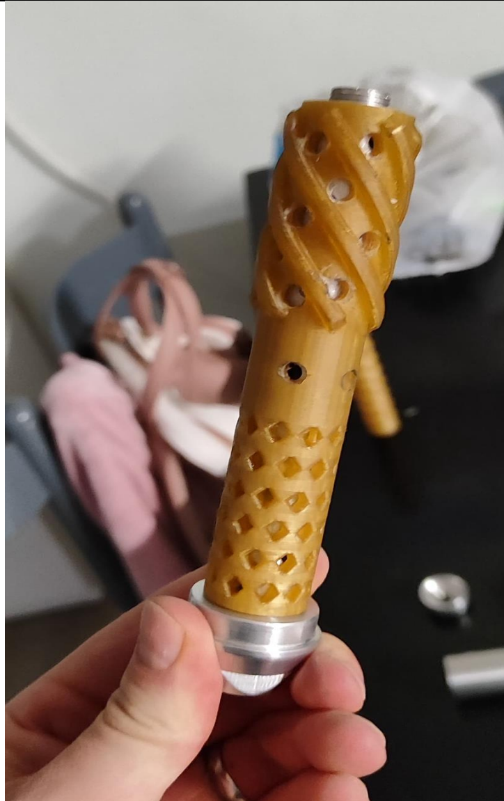
Slika 37. Prikaz FDM tiskanog modela M2
