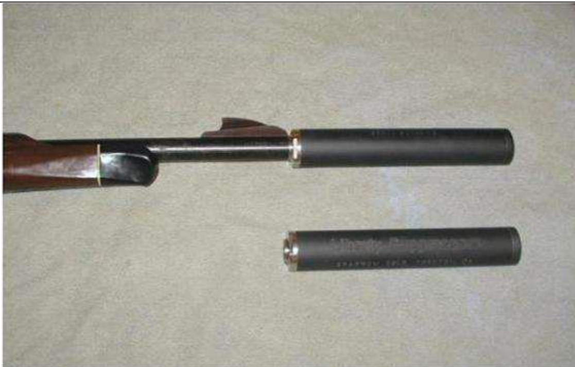
Slika 6. Prikaz moderatora koji se montira na kraj cijevi [6]
