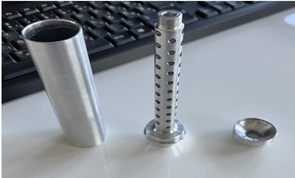
Slika 18. Prikaz dijelova moderatora zvuka od aluminija
