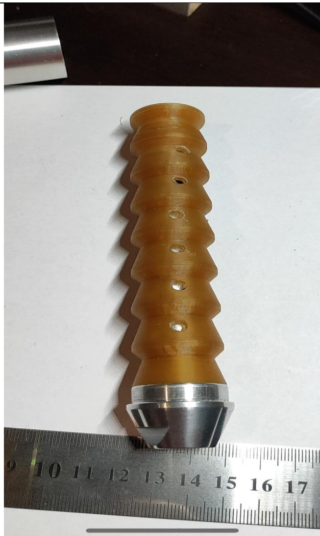
Slika 38. Prikaz FDM tiskanog modela M3
