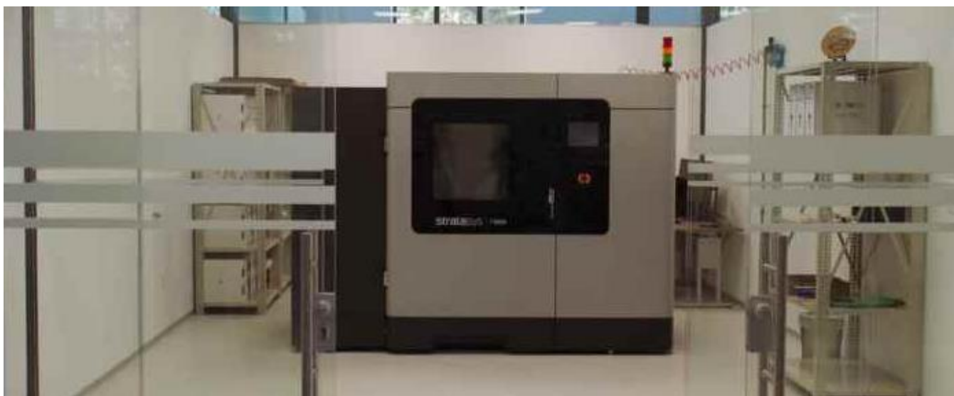
Slika 33. STRATASYS F900, profesionalni uređaj za FDM tiskanje [28]
