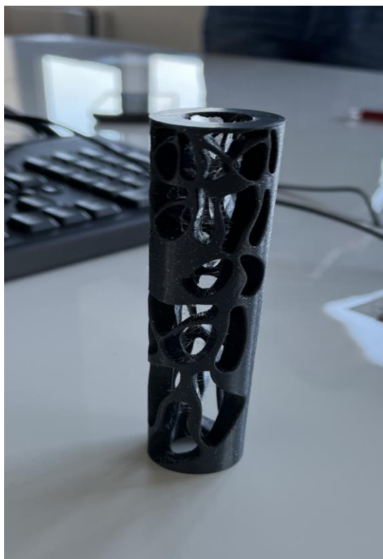
Slika 31. Model M1 tiskan pomoću Prusa uređaja i PETG materijala
