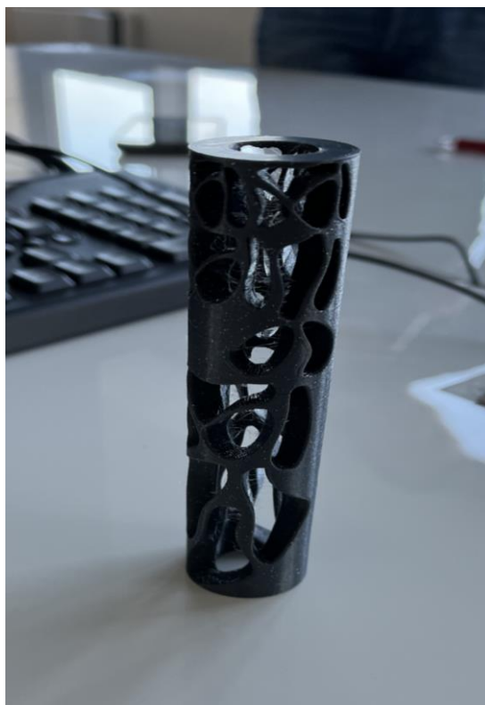
Slika 31. Model M1 tiskan pomoću Prusa uređaja i PETG materijala
