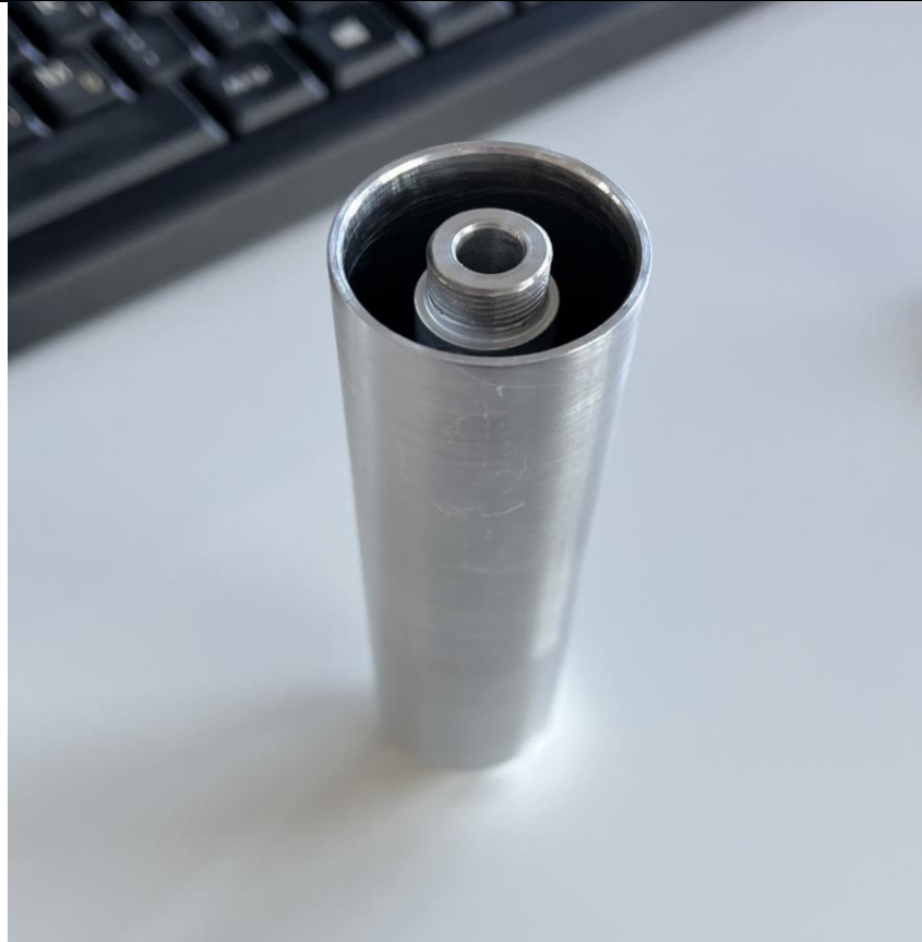
Slika 19. Moderator zvuka od aluminija bez ispune
