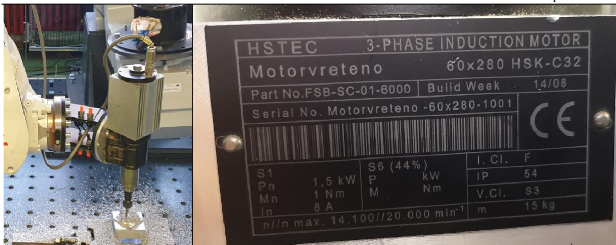
Slika 5. Motorvreteno pričvršćeno na robot R1 (lijevo) i natpisna pločica (desno)
