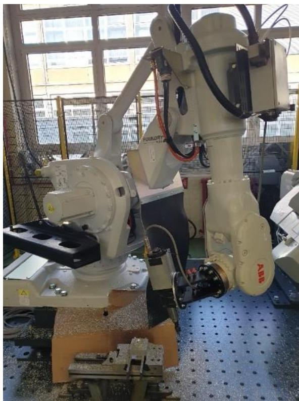
Slika 2. Izgled robota ABB IRB 6660-205/1.9 (R1)
